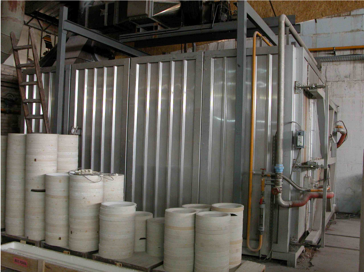
Fig.2 Le four-cellule à brûleurs Jet, porte fermée (en cours de cuisson).
