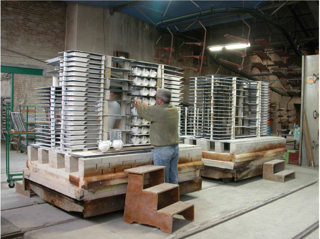
Fig.4 Chargement en porcelaine de soles mobiles.
