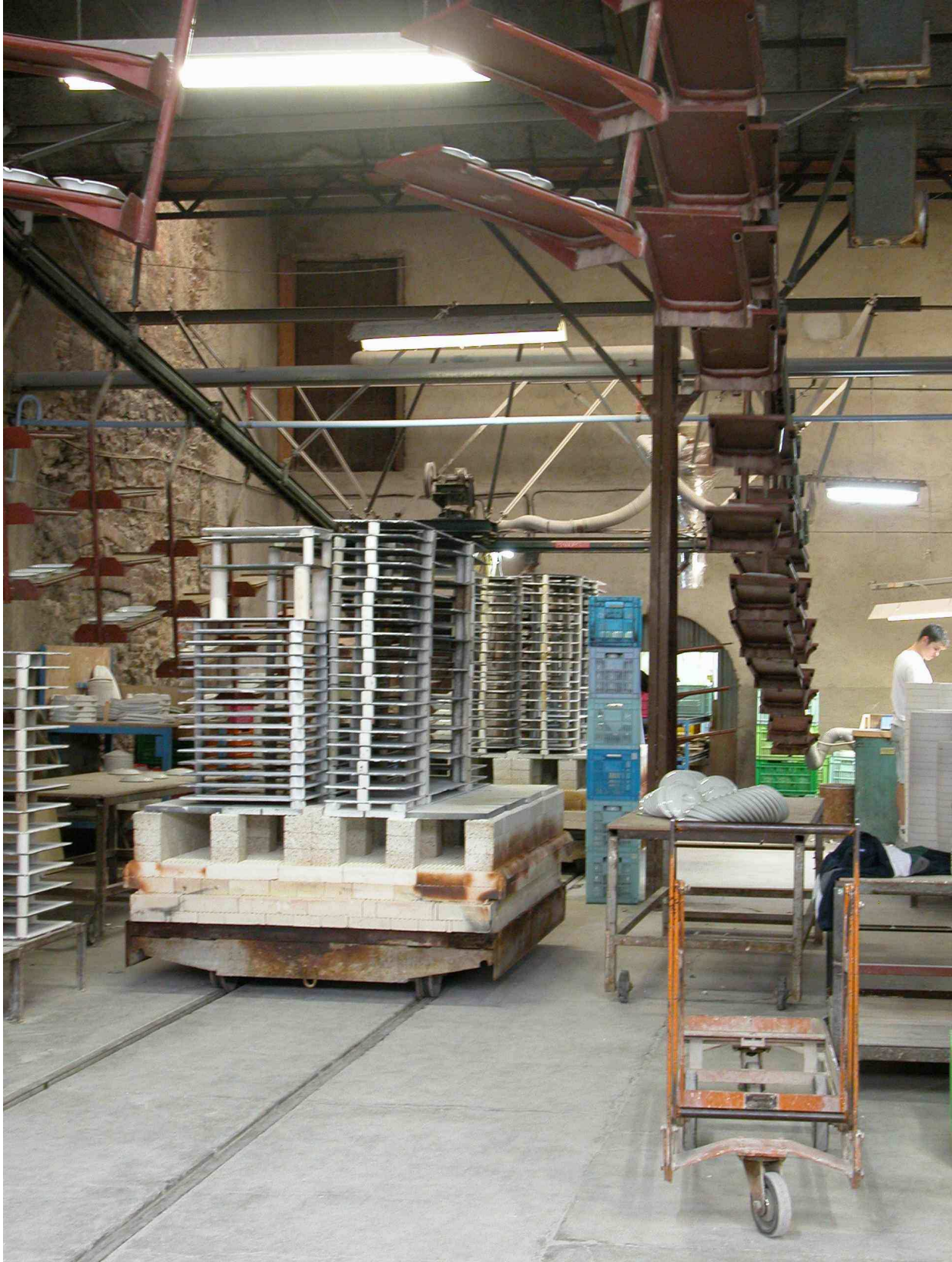
Fig.5 Chargement en porcelaine d'une sole mobile.
