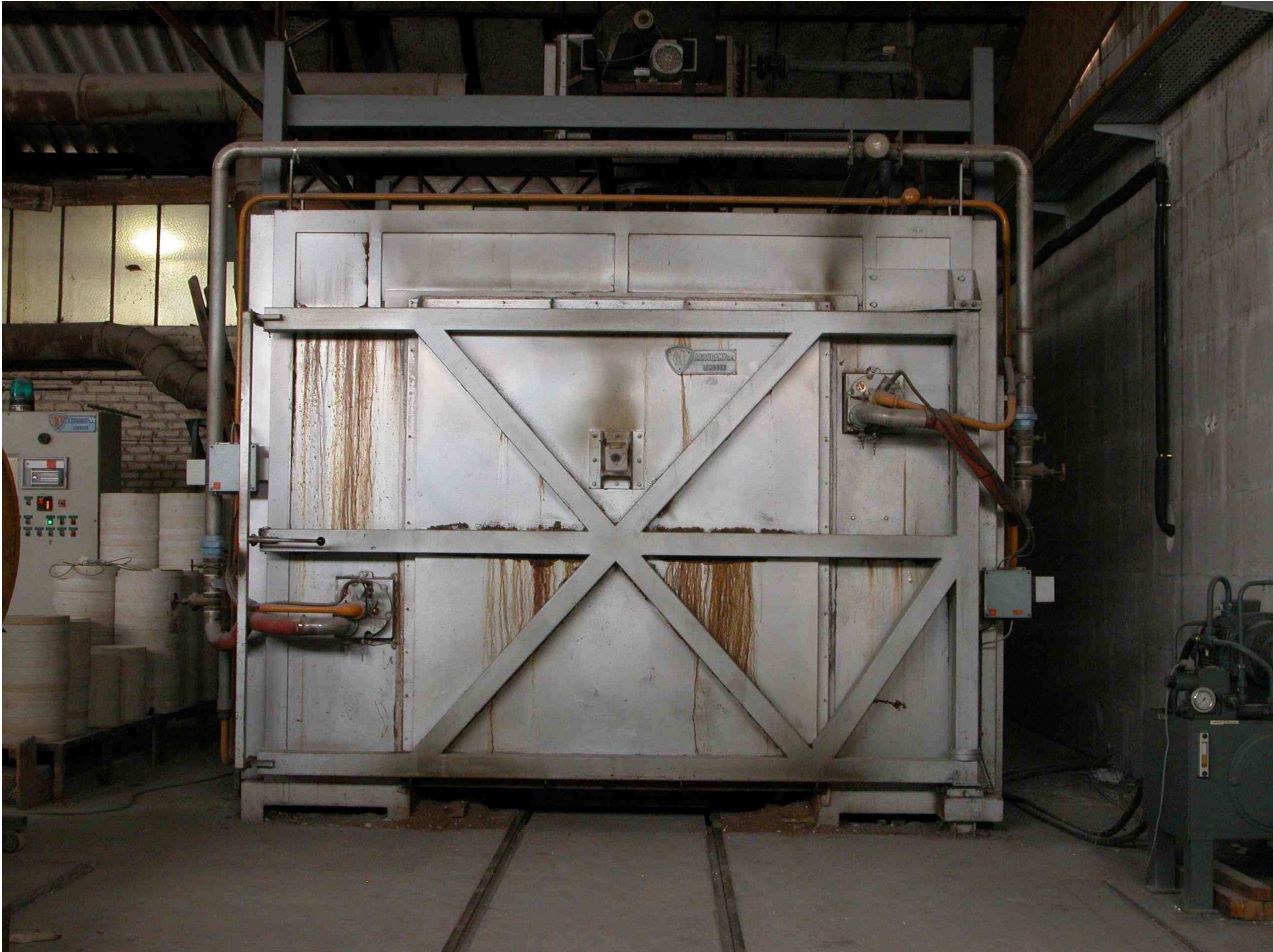
Fig.1 Le four-cellule à brûleurs Jet, porte fermée (en cours de cuisson).
