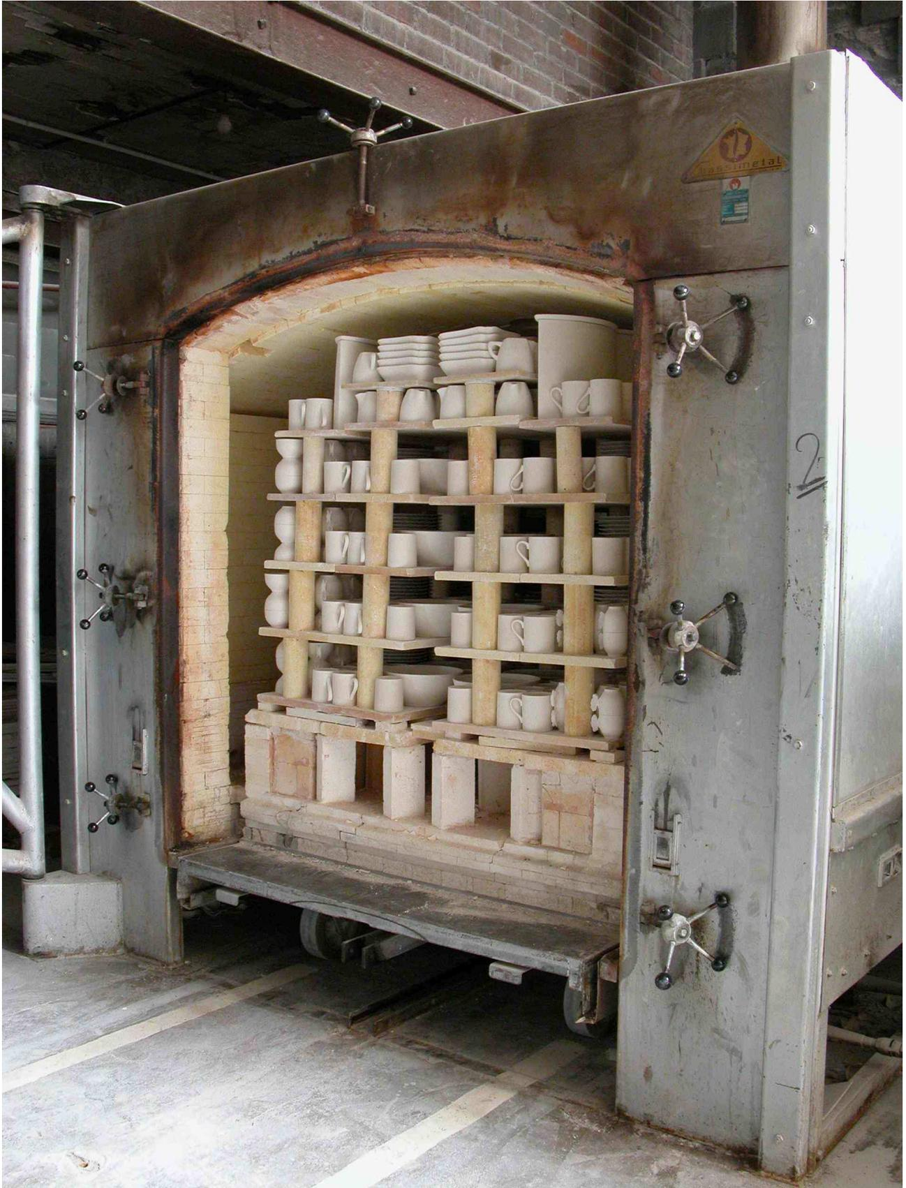
Ensemble de 2 machines à convertir : fours-cellules à dégourdi n°1 et 2
