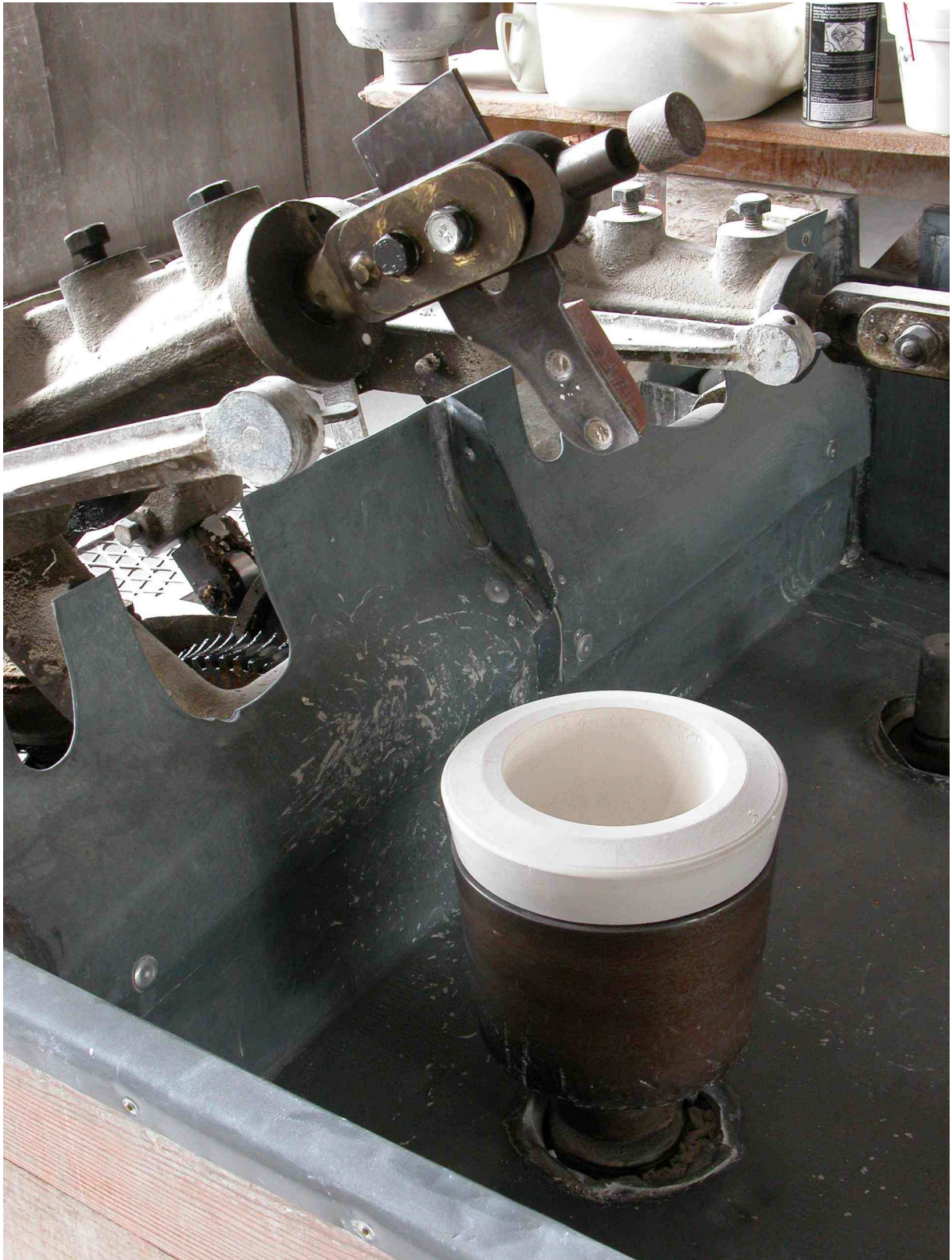
Fig.4 Vue de détail : mandrin avec moule surmonté d'un bras de bascule.
