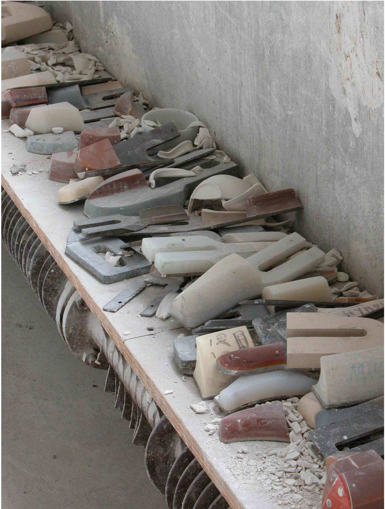
Fig.7 Calibres en acier et résine de différents profils que l'on fixe aux bras de bascule.
