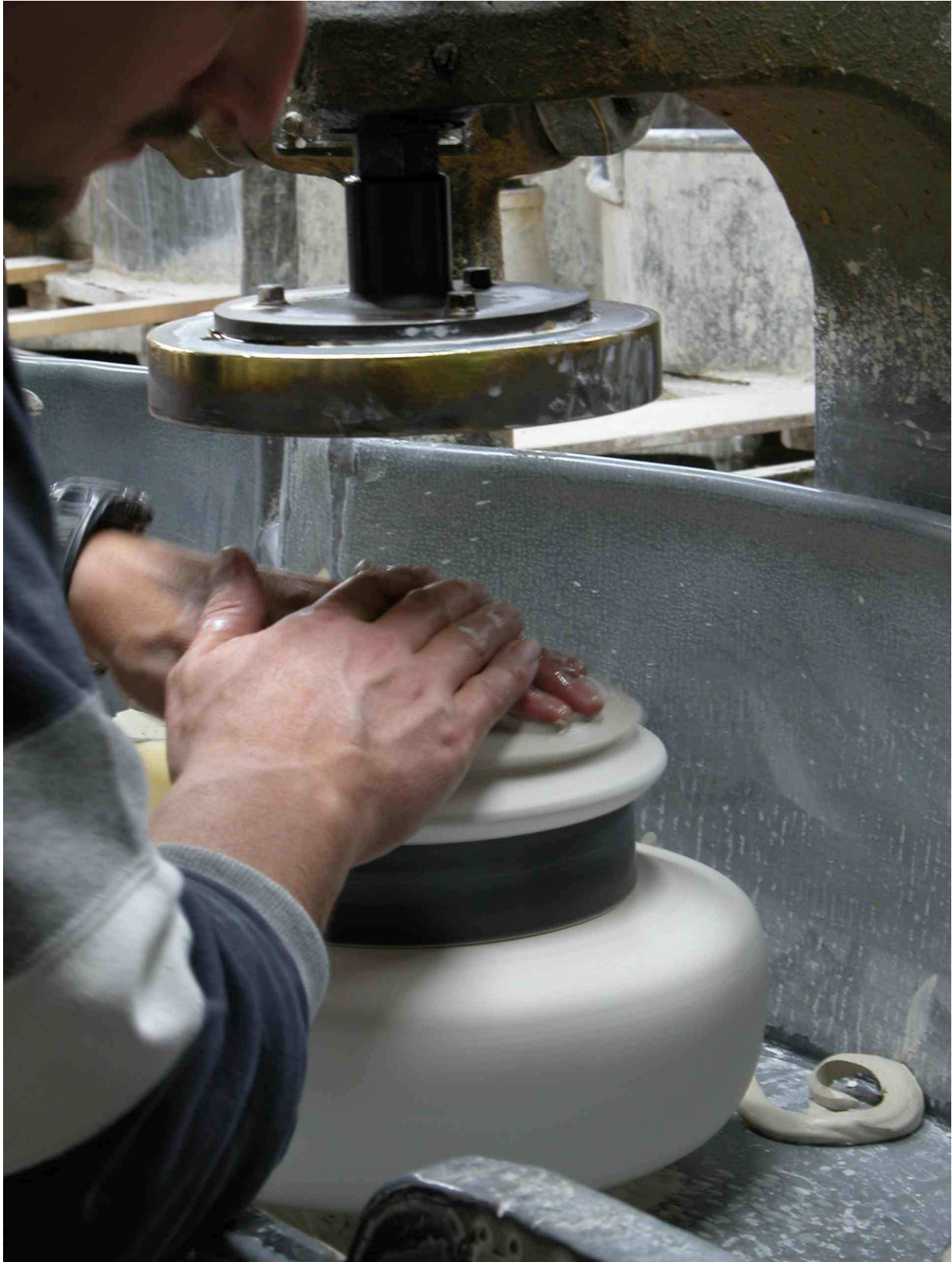
Fig.5 Opération de centrage : la croûte est appliquée à la main sur le moule.
