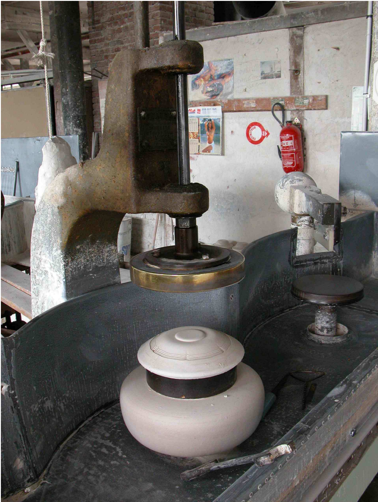
Fig.2 Opération de centrage : un moule, sans croûte, est positionné sur le tour..
