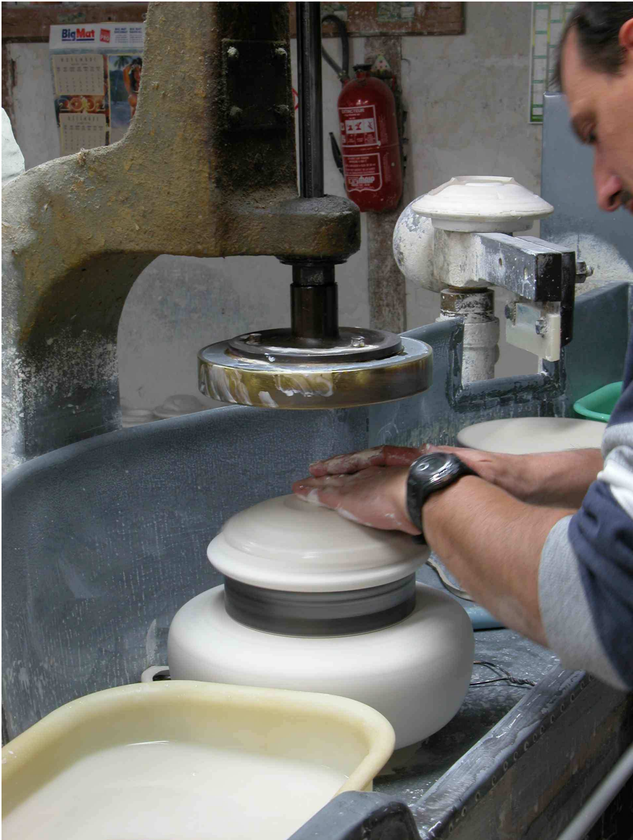
Fig.4 Opération de centrage : la croûte est appliquée à la main sur le moule.
