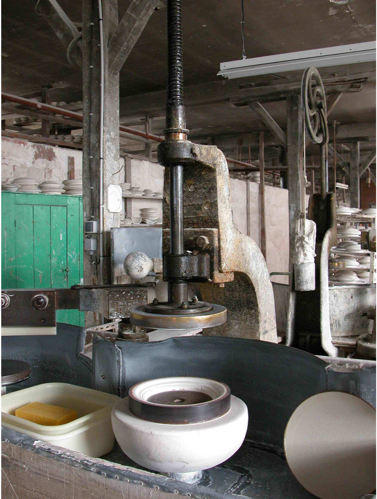
Fig.1 Vue générale de l'une des 4 centreuses.
