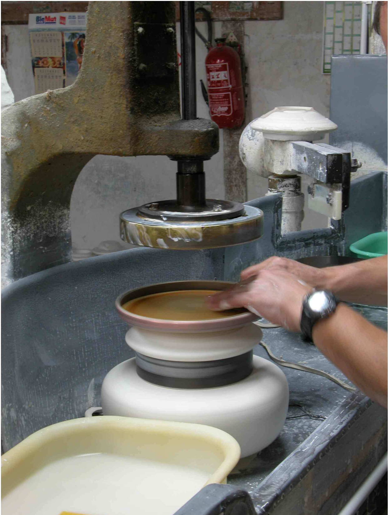
Fig.3 Opération de centrage : la croûte est abaissée sur le moule.
