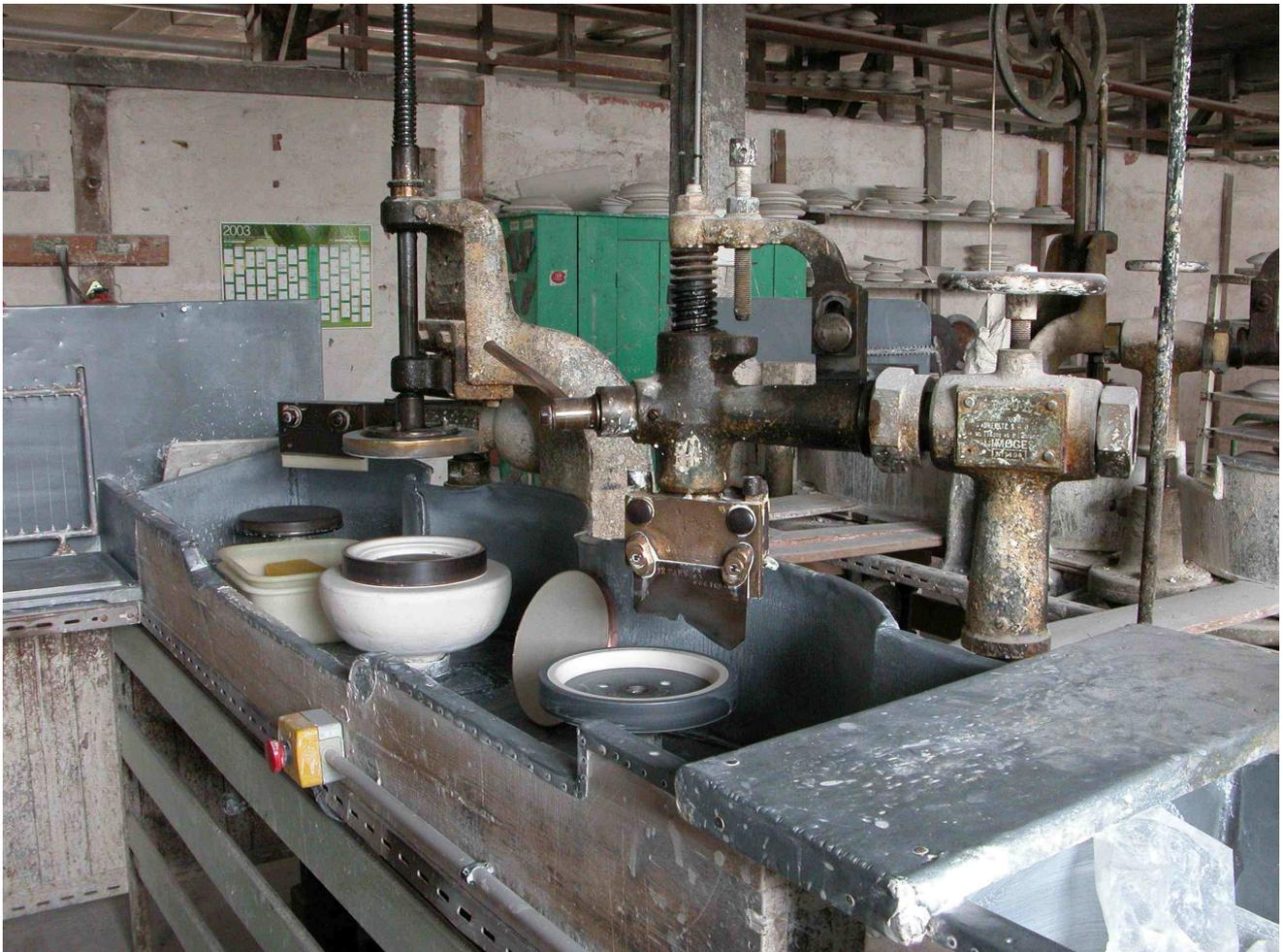
ensemble de machines à mouler et calibrer n°2 (4 machines à modeler, 4 machines à former par moulage, 4 machines à usiner) : triptyques Faure
