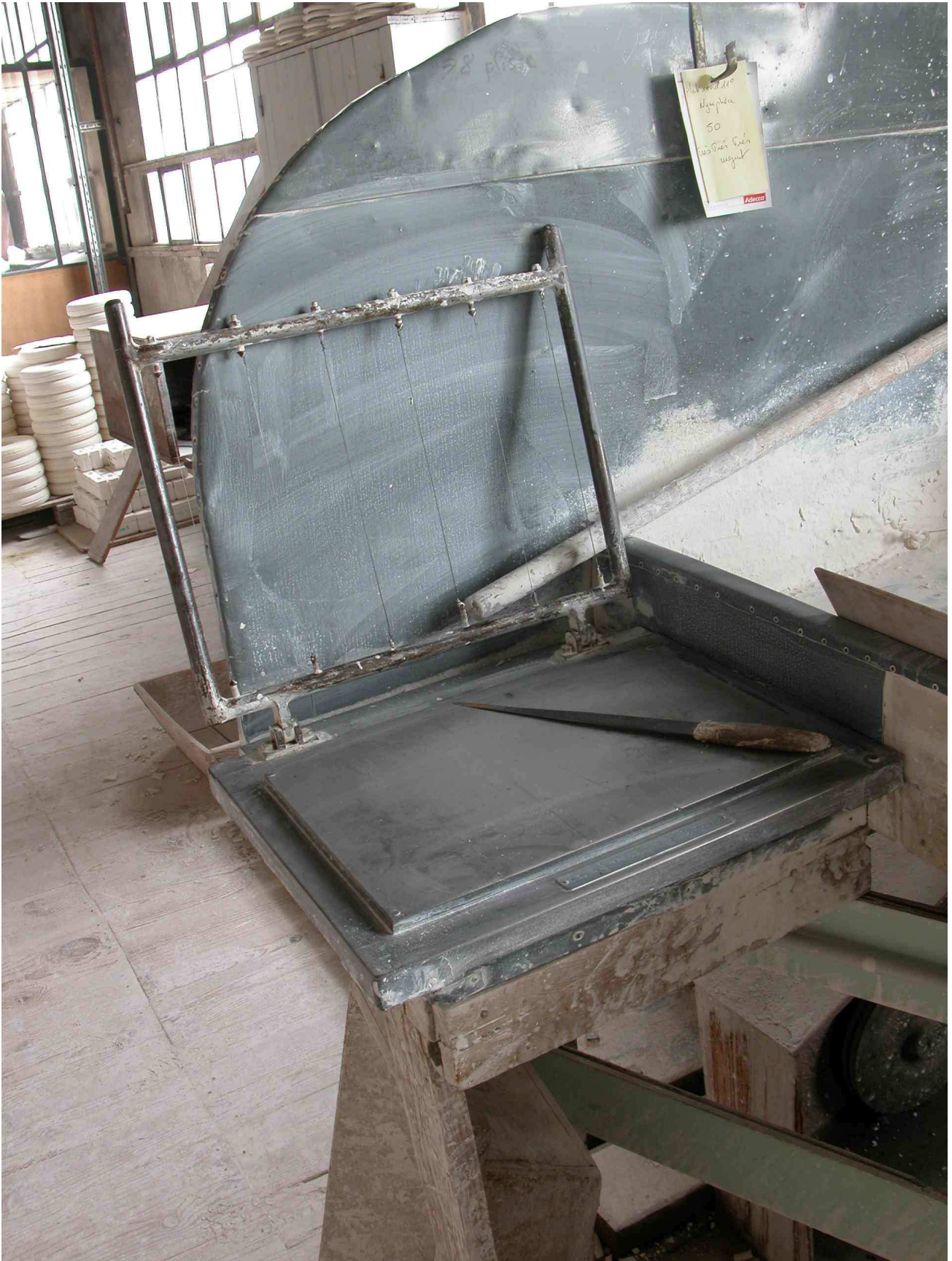
Fig.4 Appareil destiné à découper la pâte à porcelaine avant la préparation de la croûte.
