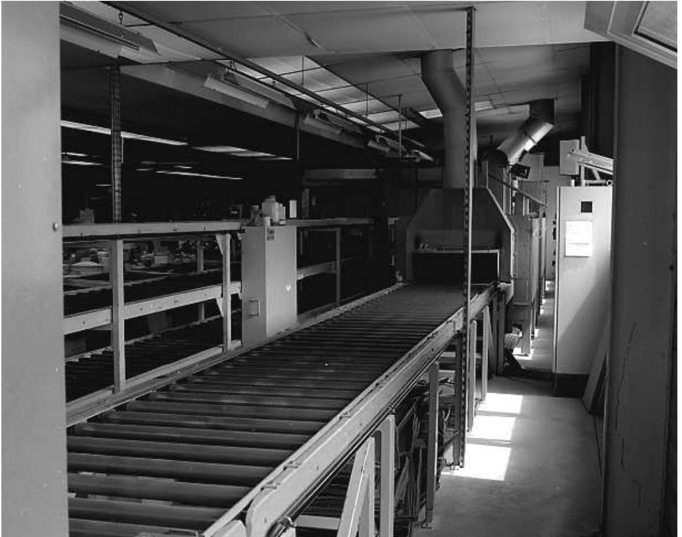
Fig.2 Four-tunnel pour la cuisson des décors : vue de l'orifice de défournement.
