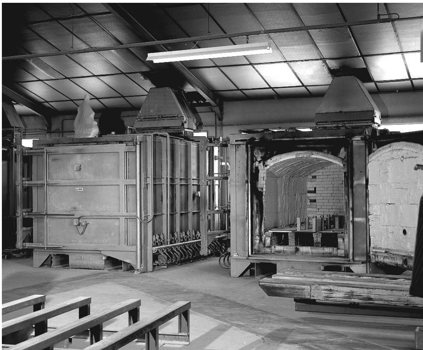
Fig.1 Les deux fours-cellules Dupeux pour la cuisson de dégourdi. La porte du four de droite est ouverte.
