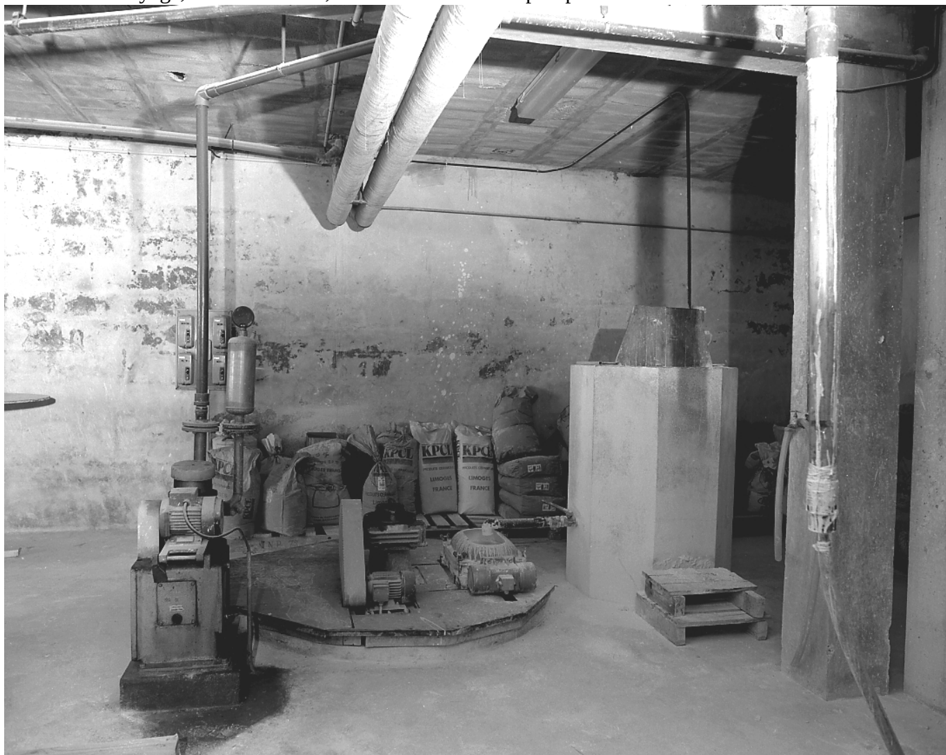
Fig.1 Ateliers des "marches à pâte" : vue générale des équipements de préparation de l'émail. De droite à gauche, la première cuve de délayage, le filtre vibrant, la seconde cuve et la pompe.
