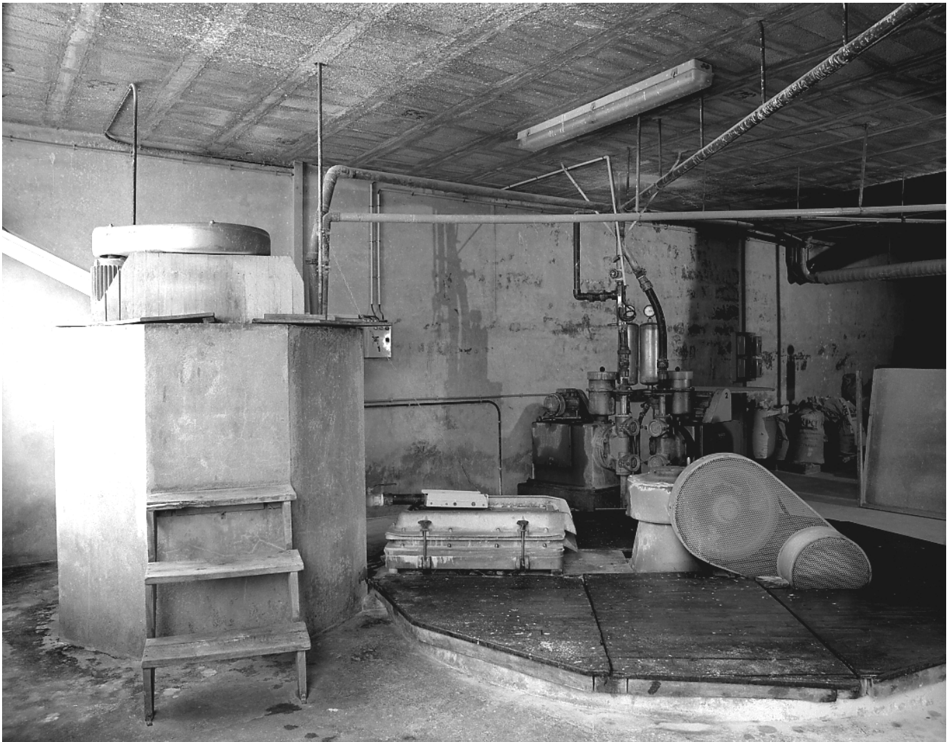
Fig.1 Ateliers des "marches à pâte" : vue générale des équipements de préparation de la barbotine. De gauche à droite, la première cuve de délayage, le filtre vibrant, la seconde cuve et les pompes (en arrière plan).
