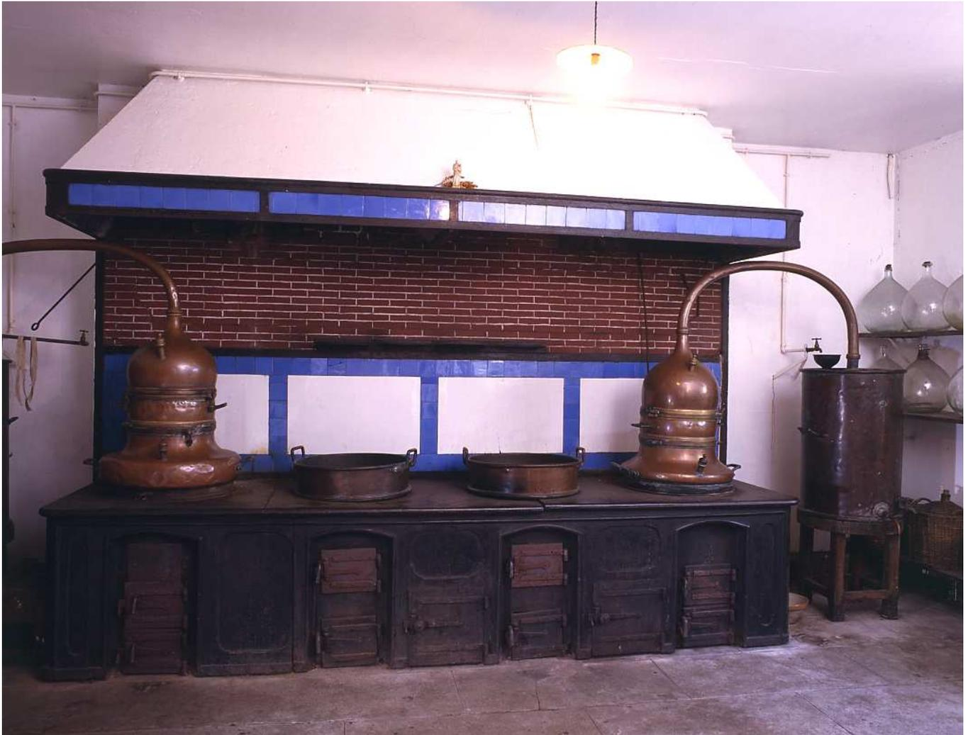
Fig.2 Vue de l'alambic et de son réfrigérant situés à gauche du fourneau.
