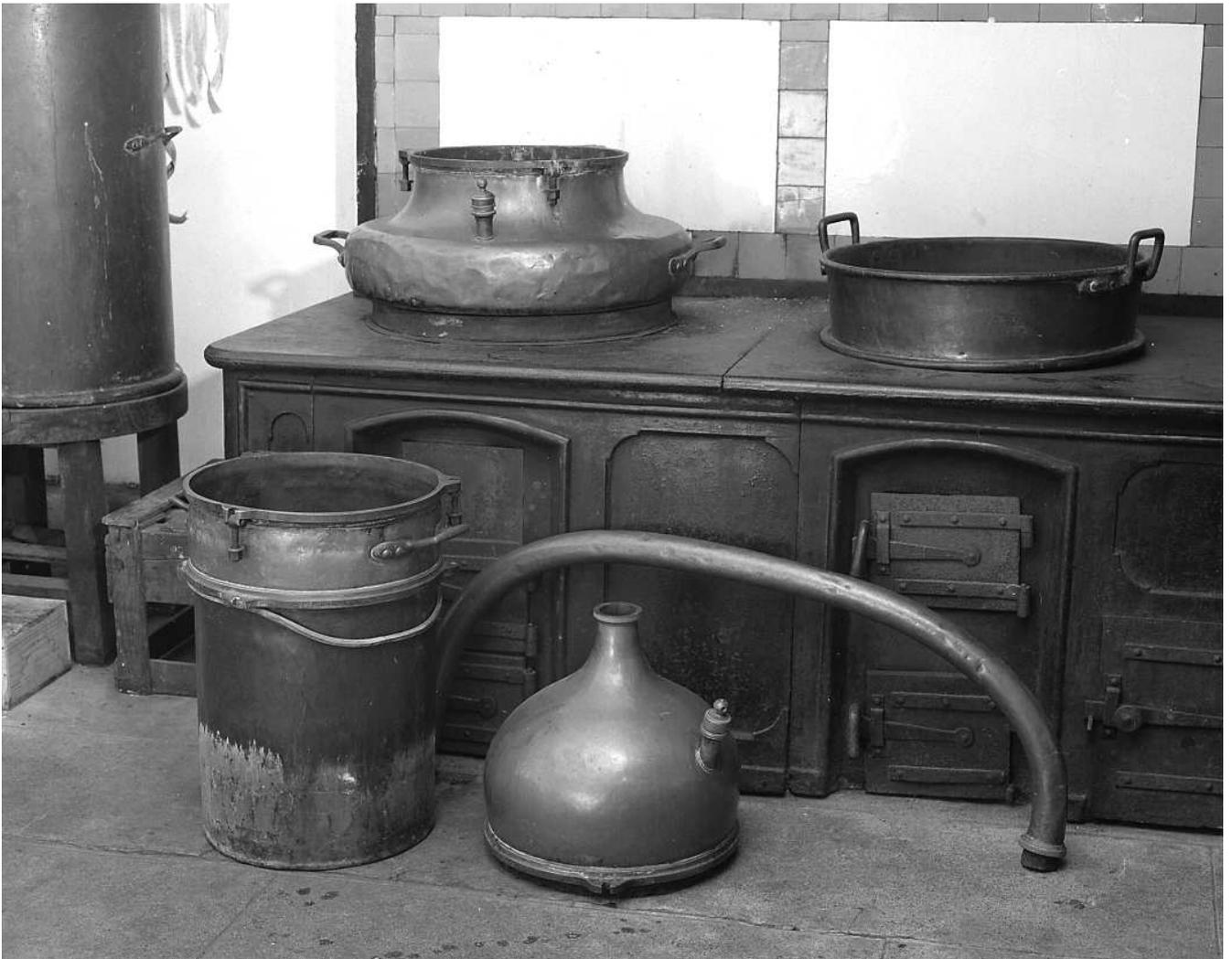
Fig.4 Vue de l'alambic et de son réfrigérant situés à droite du fourneau.
