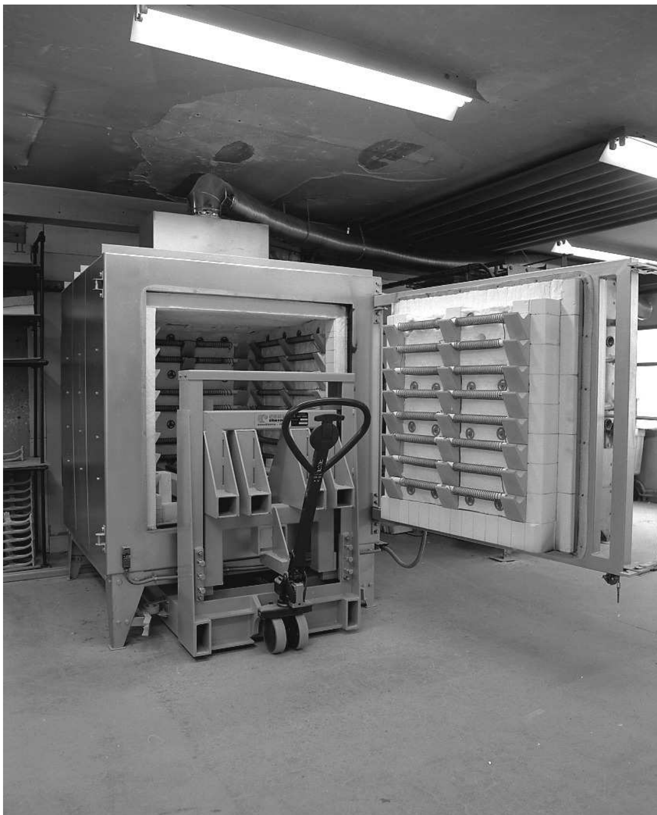
Fig.1 Four-cellule électrique pour la cuisson des décors à haute température (dans l'émail).
