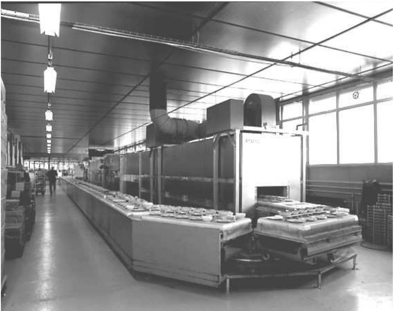
Machine à convertir : four-tunnel
