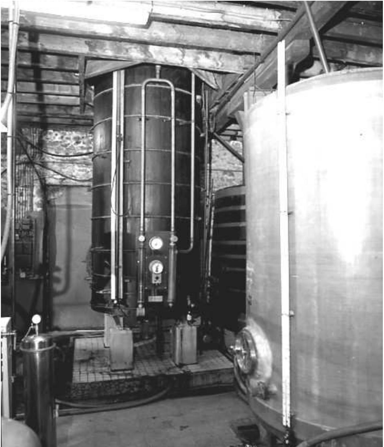
Fig.3 Cuves en fibre de verre (premier plan) et en bois desservant les acétificateurs Acetator Frings.
