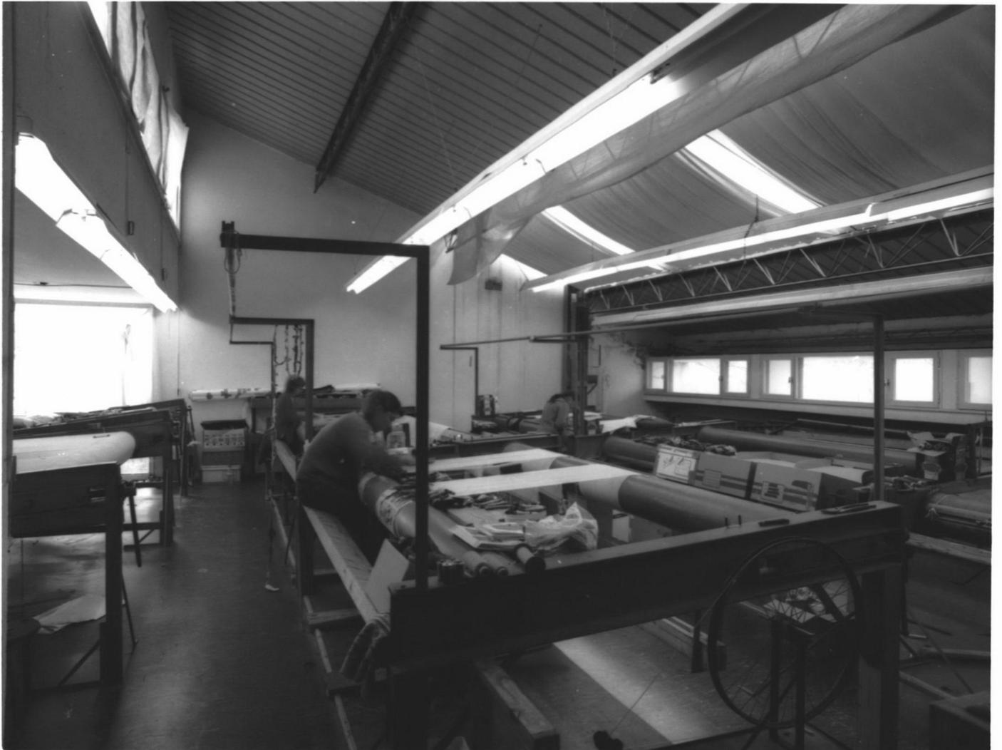
Fig. 2 Vue du métier à tisser utilisé dans le cadre d'une formation et donc pour la réalisation en exercice et simultanément de deux tapisseries. Ce métier est en général, plutôt animé par deux lissiers travaillant au tissage d'un même ouvrage de grande taille.
