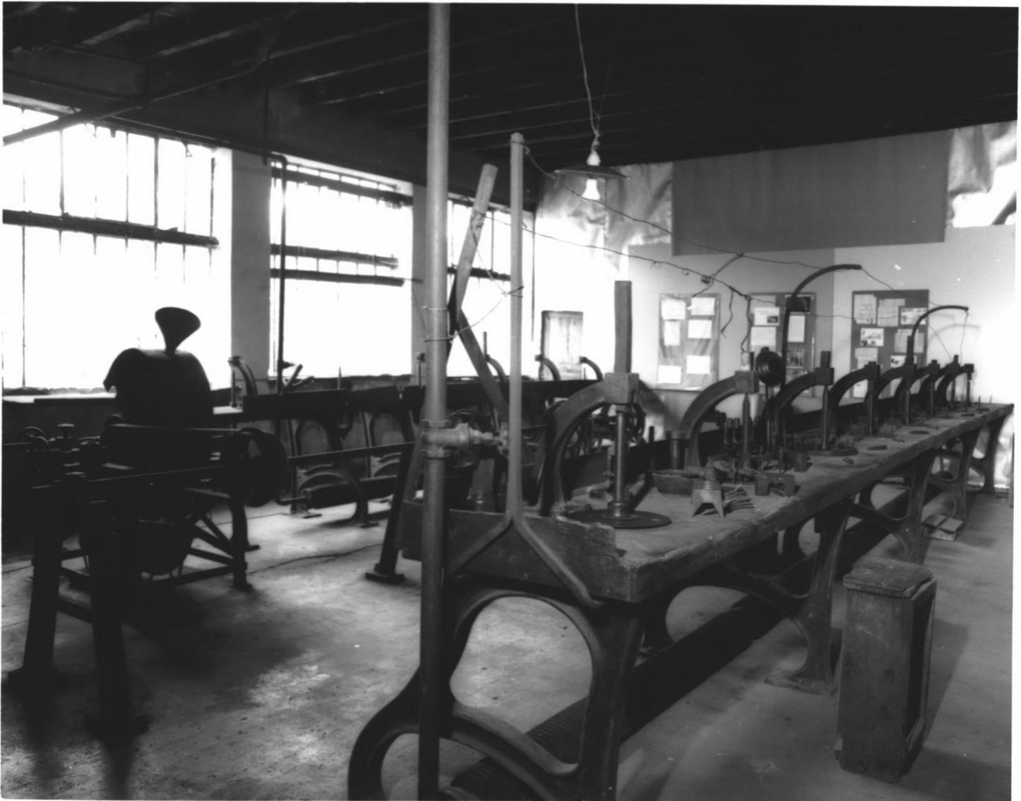
Fig. 2 Détail d'un métier diamantaire. A droite, un chalumeau à gaz. Au centre, un plateau abrasif sur lequel sont disposés les dops insérés dans leur support.
