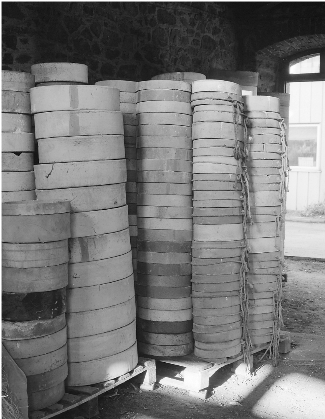
Fig.22 Empilement de gazettes pour la cuisson de la porcelaine. Les gazettes fendues sont maintenues par de cordelettes.
