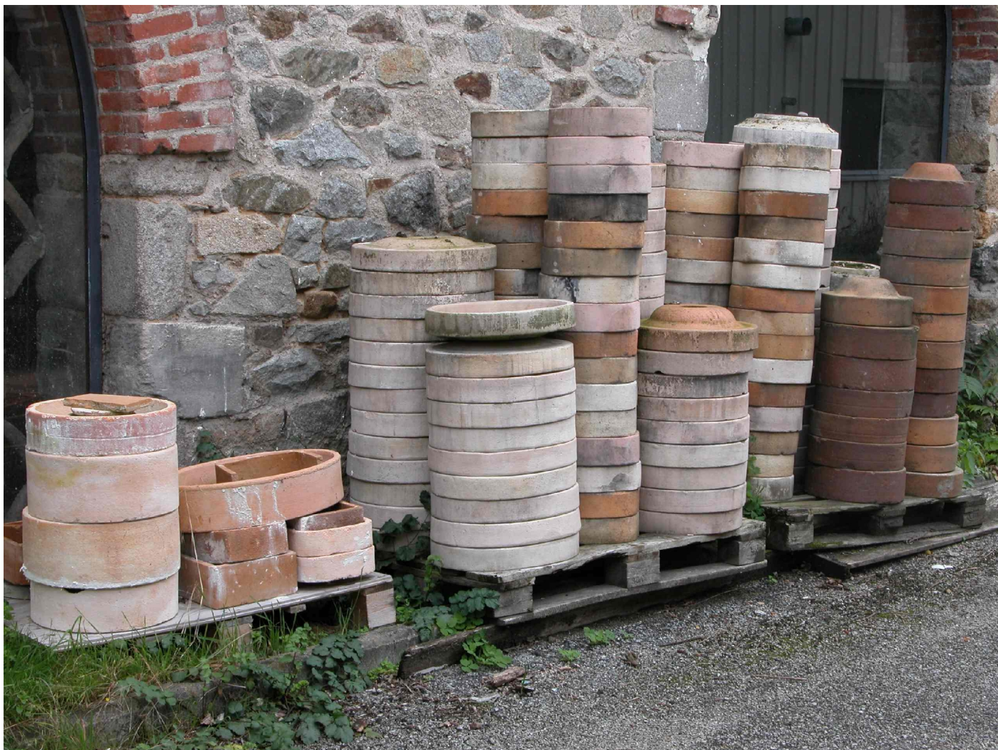
Fig.24 Empilements d'anciennes gazettes qui servaient à la cuisson de la porcelaine dans les fours à globes.
