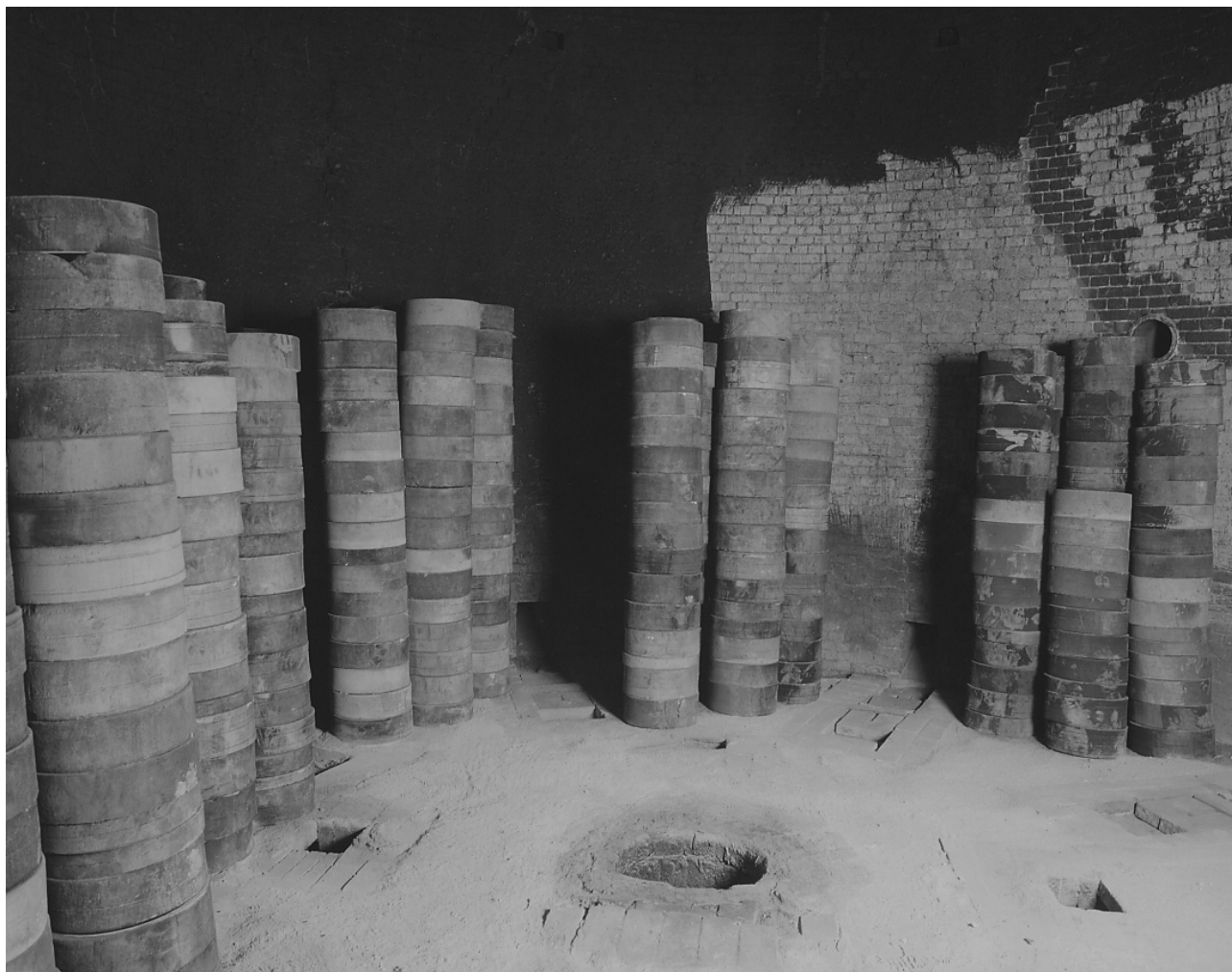
Fig.19 Empilement de gazettes dans le globe du four des Casseaux.
