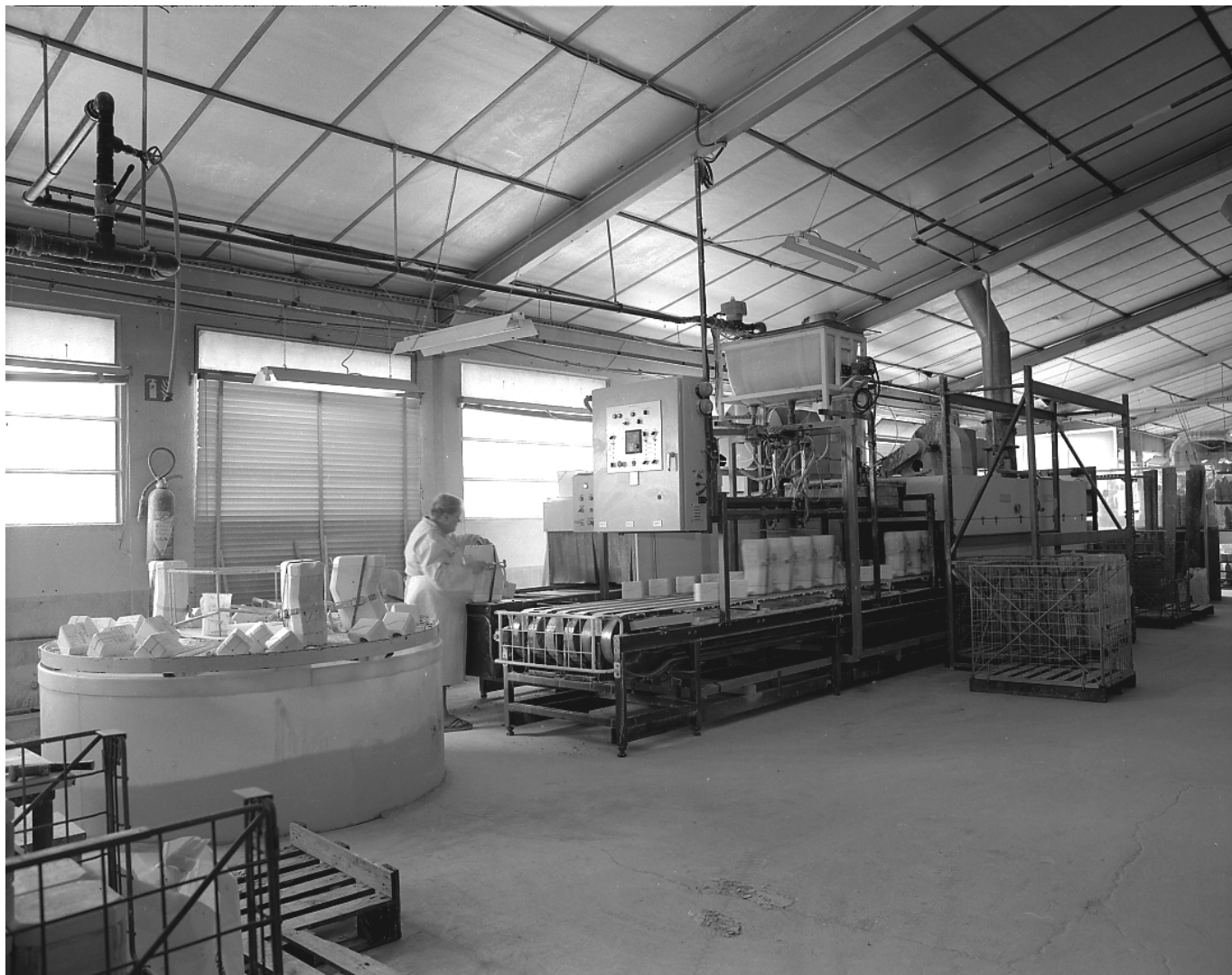
Fig.7 Machine automatique de coulage, équipée d'un séchoir au gaz, construite vers 1985-1987. A gauche, l'égouttage des moules.
