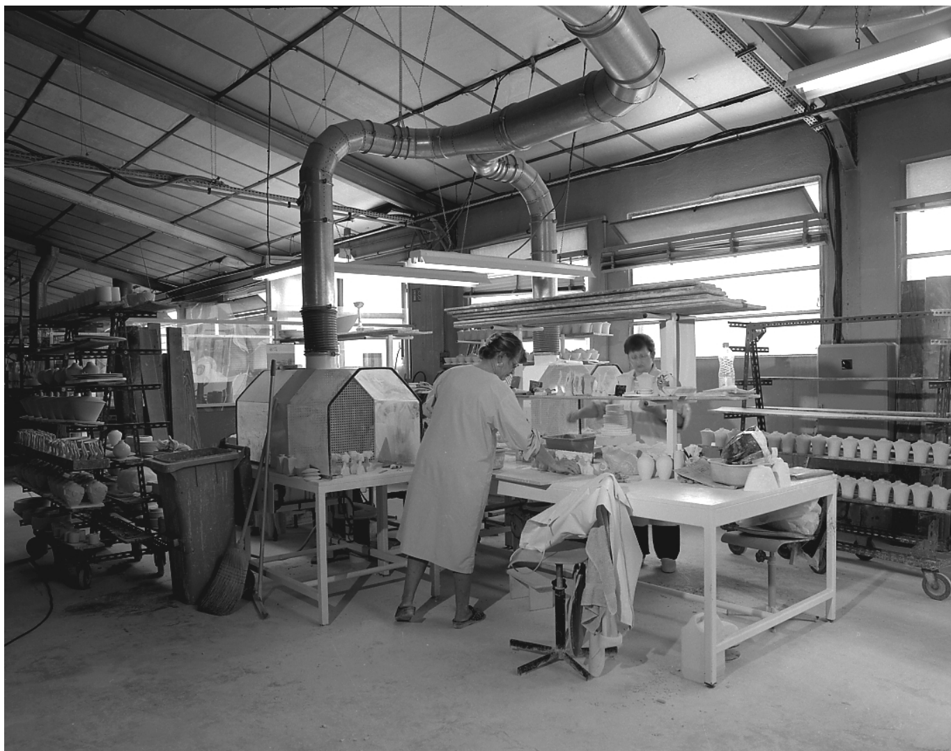
Fig.9 L'atelier de finissage des pièces après l'opération de moulage : les pièces sont préparées avant la cuisson de dégourdi.
