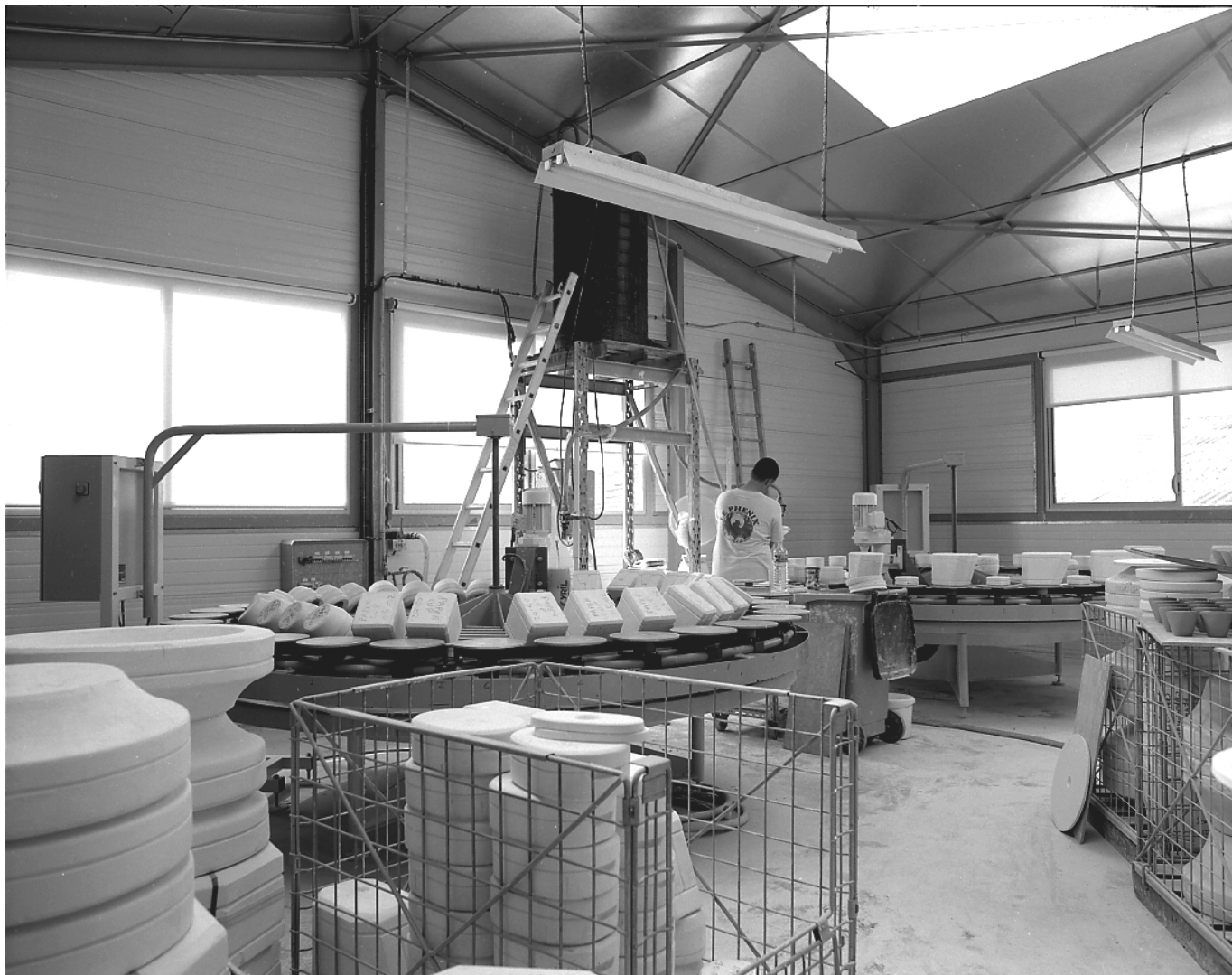
Fig.4 Atelier de coulage des pâtes de couleur : vue des deux carrousels, construits par la société ELMECERAM (Oradour-sur-Vayres, 87) en 2001.
