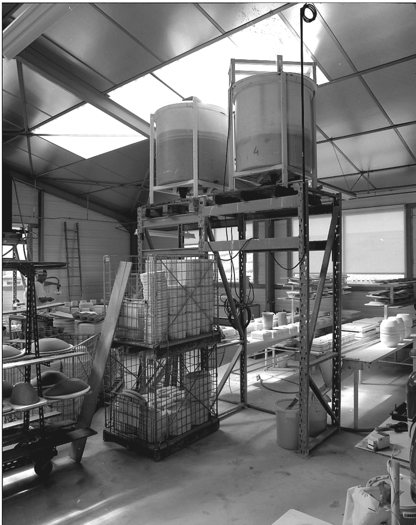
Fig.5 Atelier de coulage des pâtes de couleur : vue des deux tables de coulage manuel et des deux réservoirs de barbotine associés.
