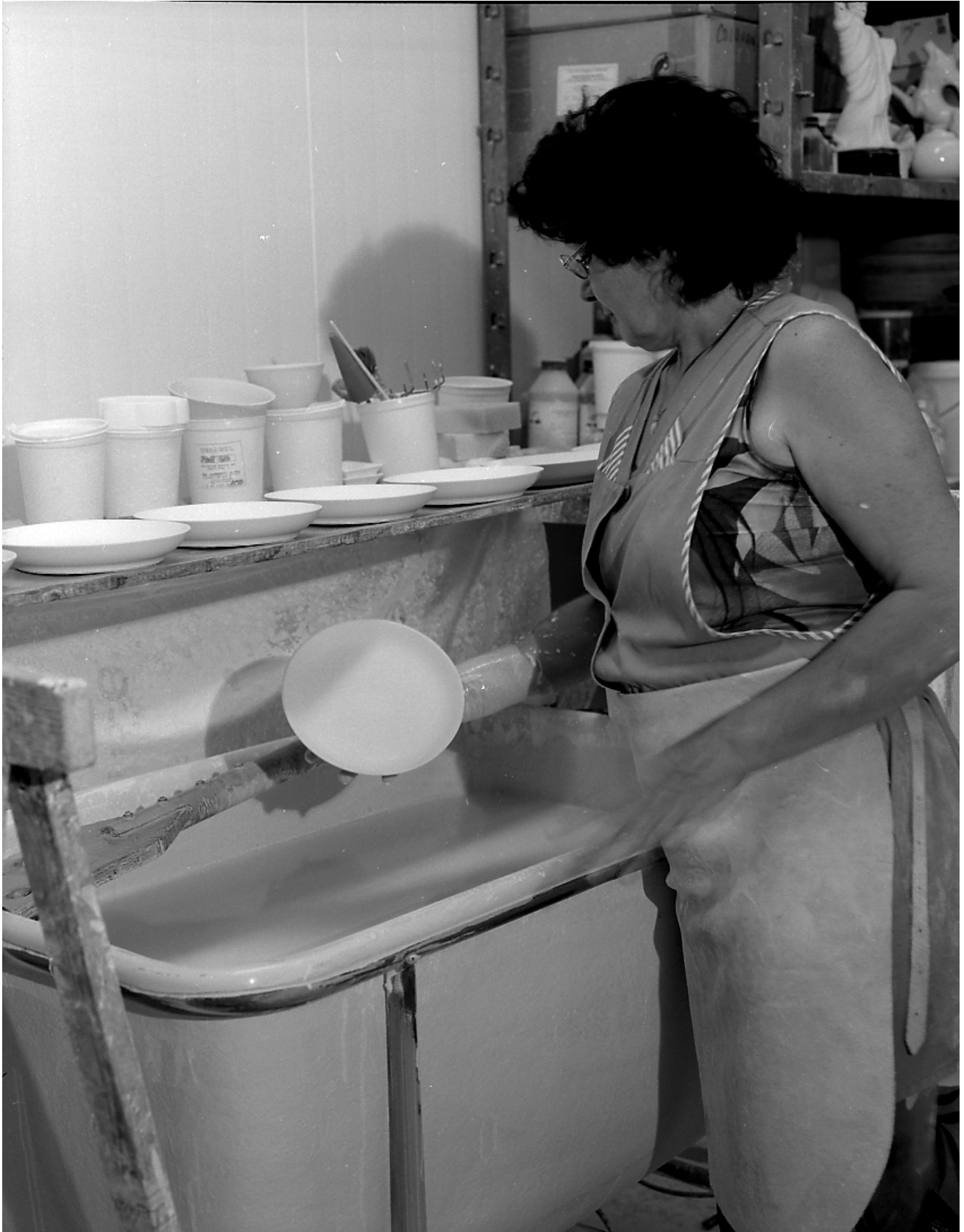
Fig.10 Atelier de fabrication : émaillage d'une assiette.
