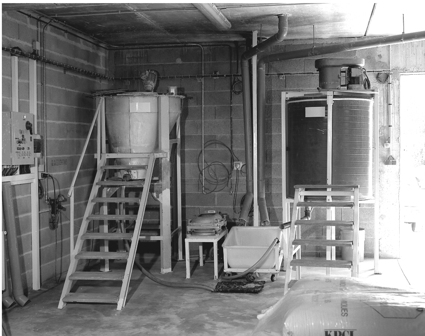
Fig.3 Atelier de préparation de la barbotine pour les pâtes de couleur : il est doté de deux cuves de préparation. La cuve de droite, en résine, est équipée d'un agitateur à hélice du constructeur italien Vicentini construit en 1973.
