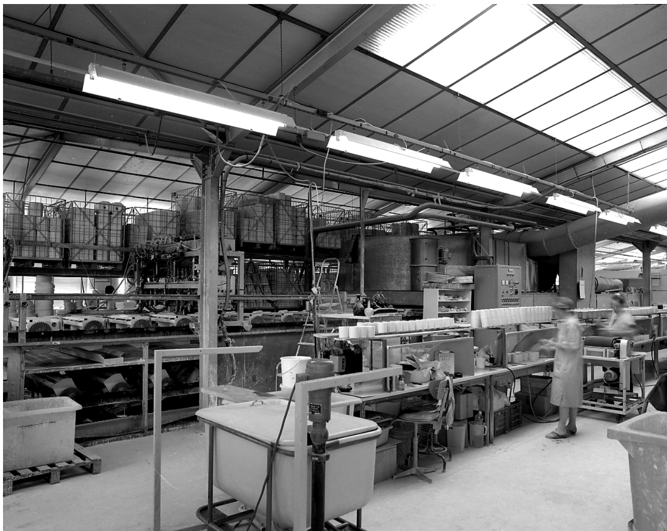
Fig.8 Atelier de fabrication : au premier plan les postes de travail pour la préparation après émaillage des pièces de porcelaine avant cuisson de l'émail, en arrière plan la machine automatique à couler de 1974.
