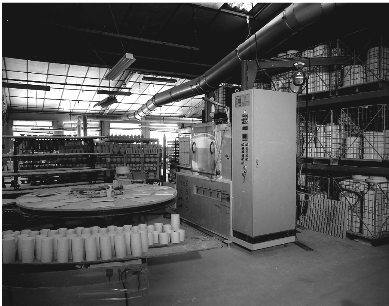
Fig.12 Atelier de coulage sous pression : presse à injection de pâte liquide construite en 1988 par la société anonyme ELMETHERM S.A. (Saint-Auvent, 87). Il n'existait que six presses de coulage en Limousin en 1988.
