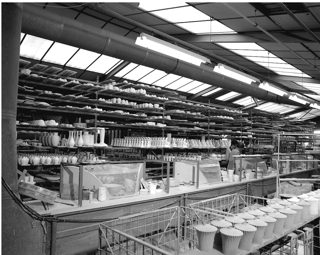
Fig.11 Atelier de fabrication : postes de travail munis d'aspiration pour la finition des pièces de porcelaine après émaillage, avant cuisson de l'émail. En arrière plan, les pièces de porcelaine en attente d'émaillage, et en séchage avant cuisson de l'émail.
