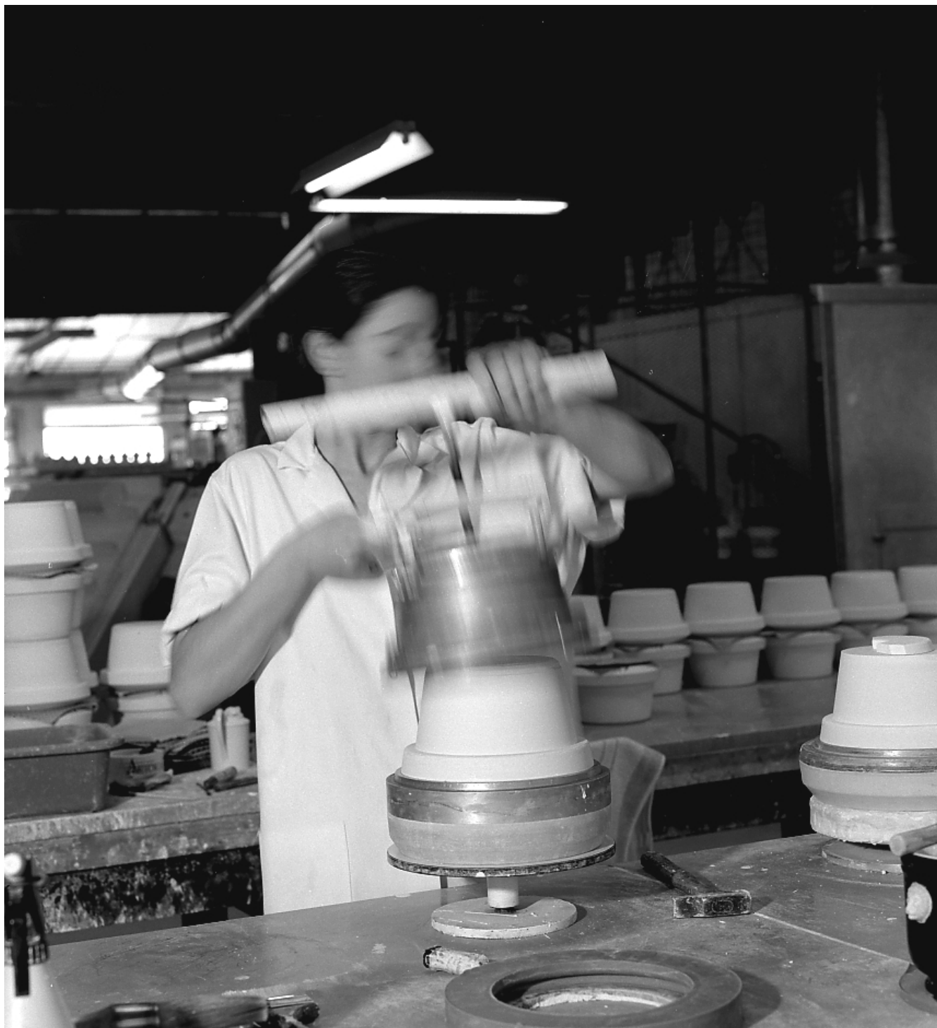
Fig.20 Atelier de fabrication des moules de travail pour la fabrication de la porcelaine (coulage et calibrage) : démoulage de la partie extérieure du moule intermédiaire.
