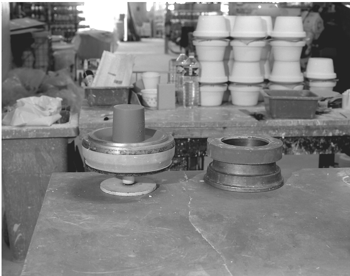
Fig.18 Atelier de fabrication des moules de travail pour la fabrication de la porcelaine (coulage et calibrage). A gauche le noyau (ou moule mère) en silicone du moule intermédiaire pour la fabrication par calibrage d'un pot à crayons, reposant sur support métallique rotatif. A droite la partie métallique du moule intermédiaire (remplace les tôles de zinc appelées cerces) qui viendra enchâsser le noyau et qui donnera la forme extérieure du moule de travail en creux pour le calibrage.
