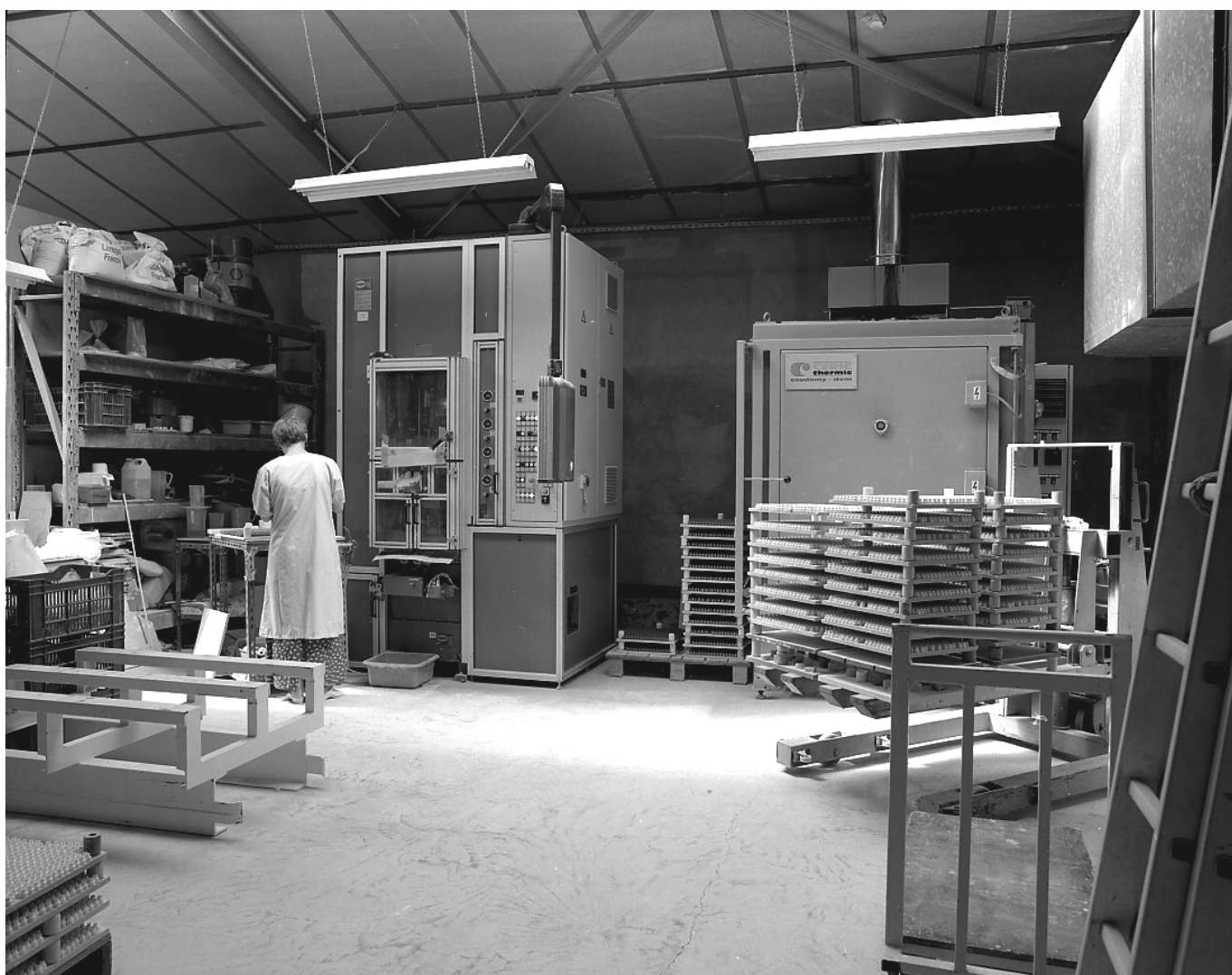
Fig.13 Atelier de fabrication de porcelaine industriel : fabrication de brûleur pour diffuseur. L'atelier est équipé d'une presse à poudre du constructeur allemand DORST construite en 1998, et d'un four-cellule du constructeur limougeaud Coudamy de 1999.
