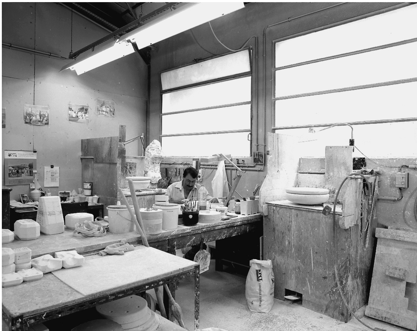
Fig.16 Atelier de fabrication des moules pour le fabrication de la porcelaine (coulage et calibrage) : réalisation des modèles.
