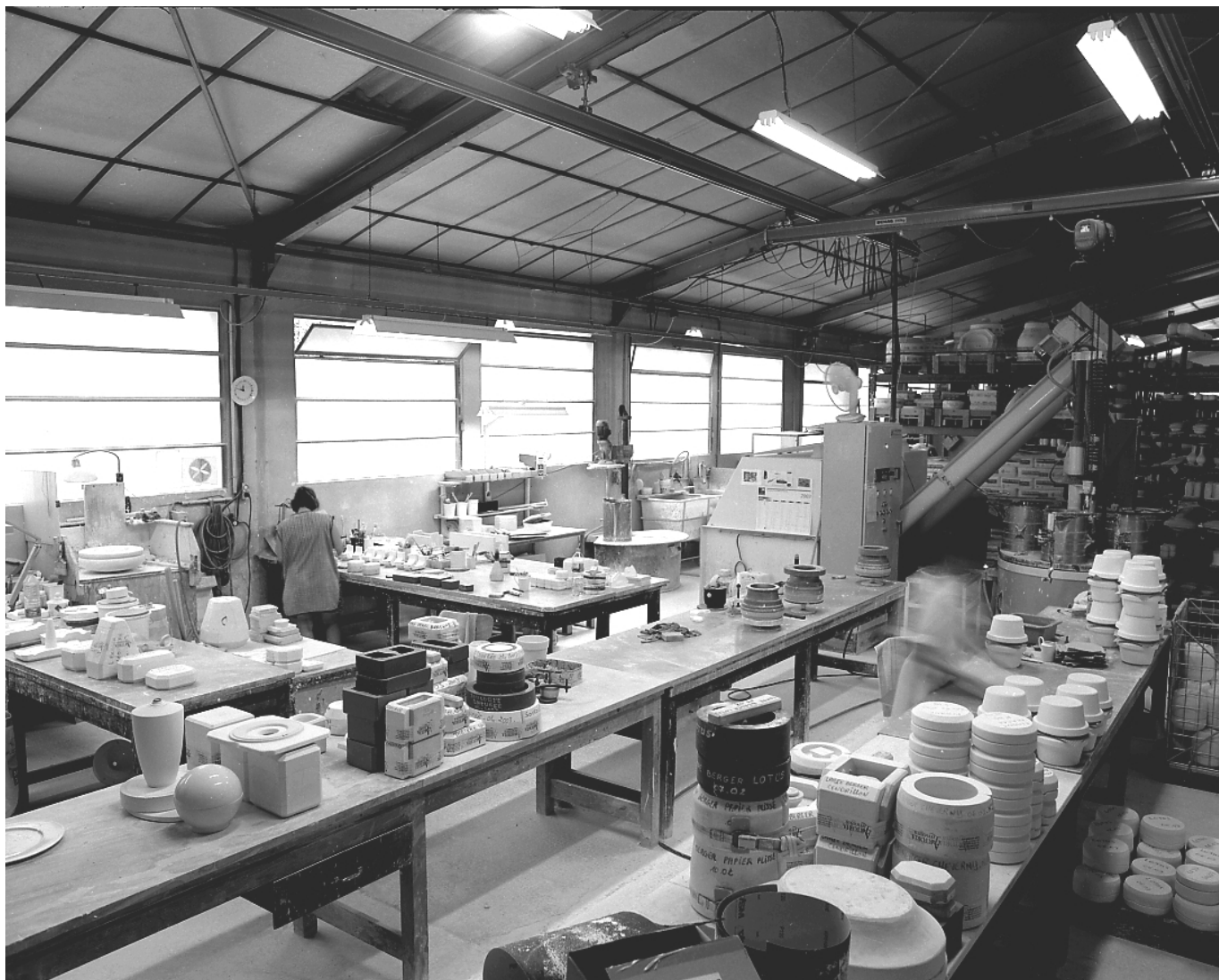
Fig.17 Atelier de fabrication des moules pour la fabrication de la porcelaine (coulage et calibrage) : vue générale. Au fond, les deux machines de préparation du plâtre : à droite la machine automatique ELMETHERM construite vers 1997, à gauche une machine VICENTINI de 1973.
