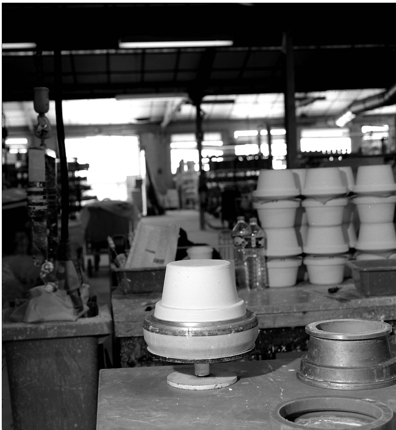
Fig.21 Atelier de fabrication des moules de travail pour la fabrication de la porcelaine (coulage et calibrage) : un moule de travail en creux pour le calibrage d'un pot à crayon, après démoulage. La partie externe du moule intermédiaire est retirée, tandis que la partie interne (noyau) est encore en place.
