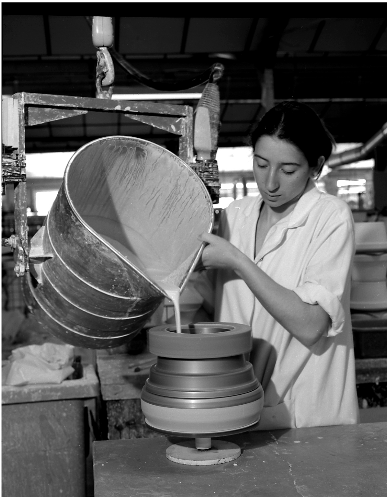
Fig.19 Atelier de fabrication des moules de travail pour la fabrication de la porcelaine (coulage et calibrage). Le plâtre, contenu dans une gâche soutenue par un treuil, est versé dans le moule intermédiaire en rotation.
