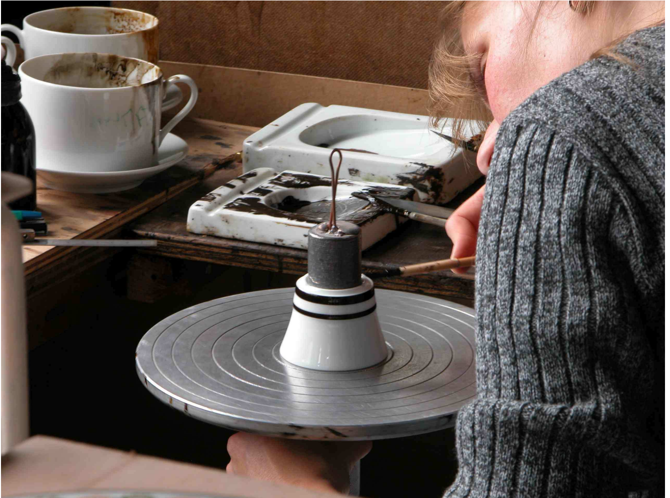
Fig.51 Poste de travail d'un fileur : pose du filet au pinceau sur une tasse à café, maintenue par une petite masse de plomb.
