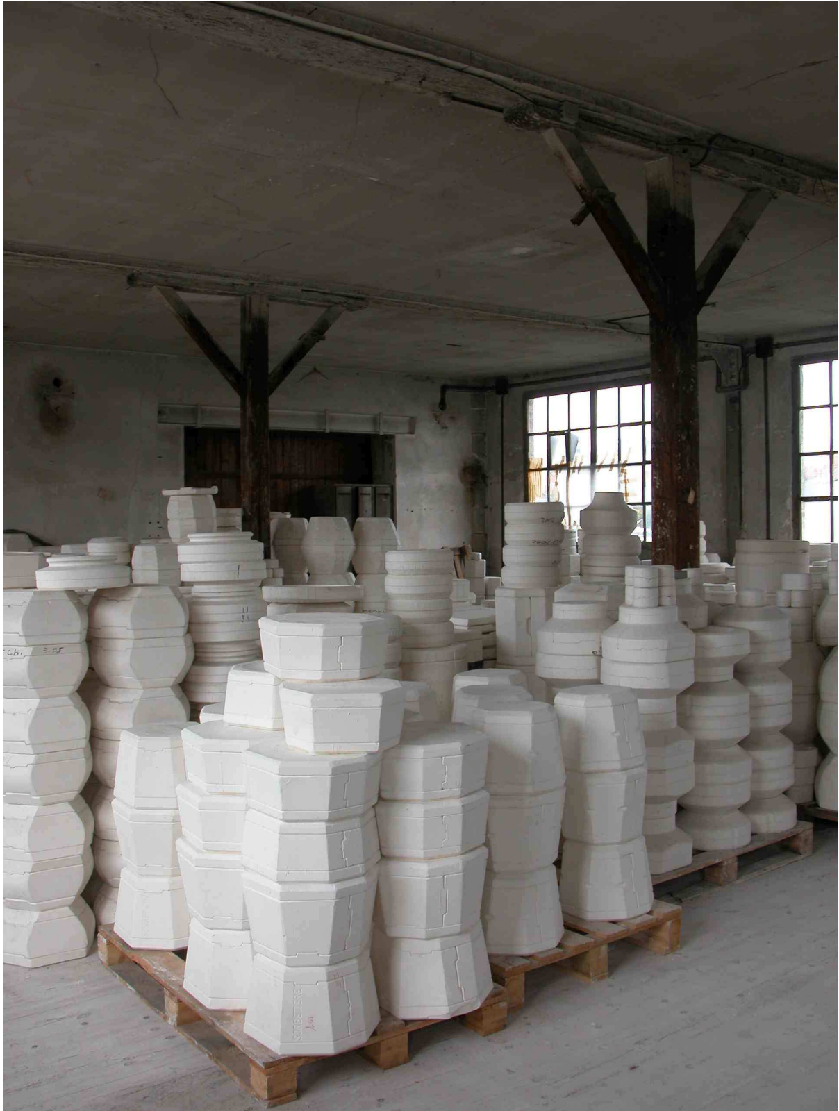
Fig.15 Stockage de moules pour l'atelier voisin de coulage des grosses pièces.
