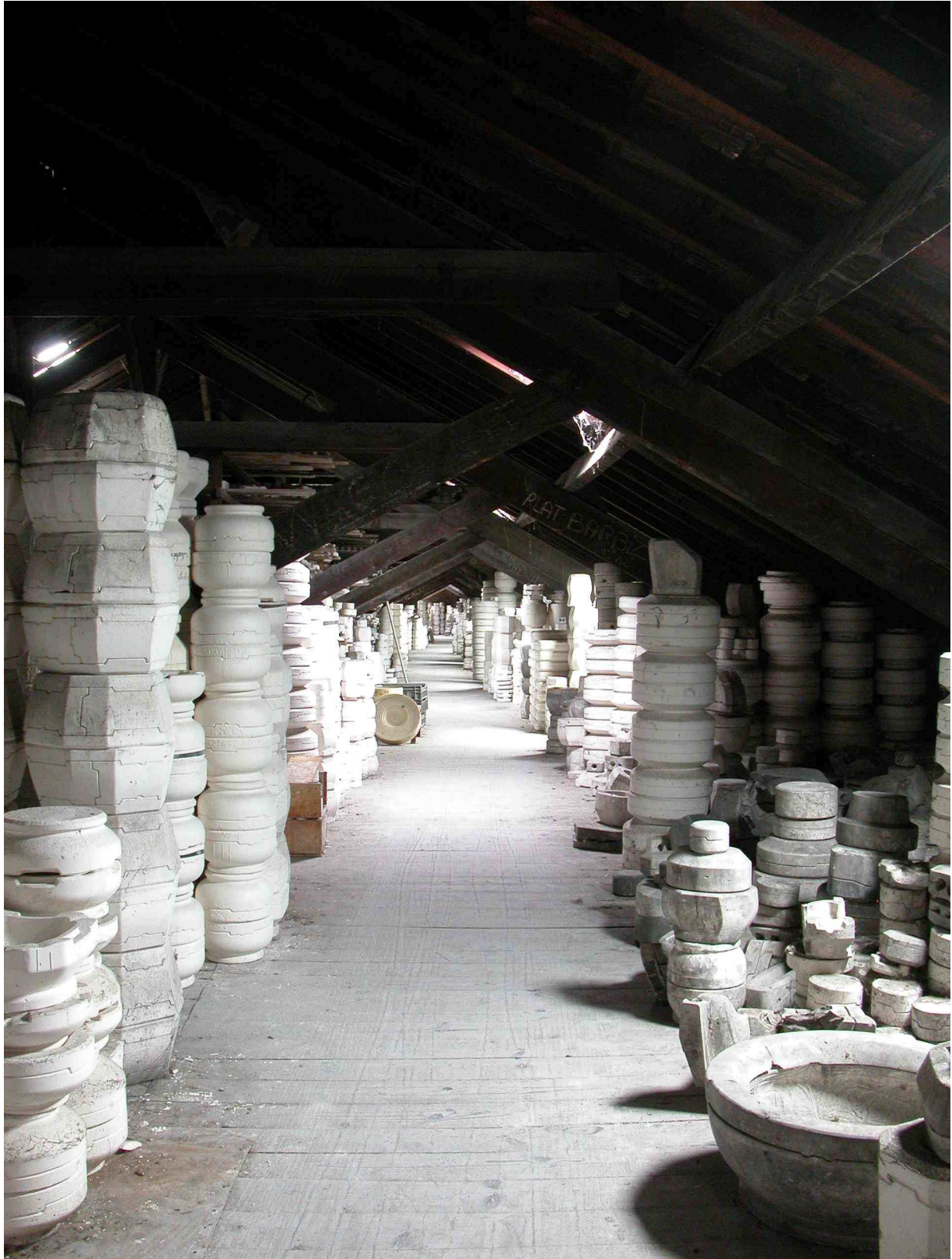
Fig.36 Stockage des moules pour le coulage dans les greniers des ateliers de fabrication.
