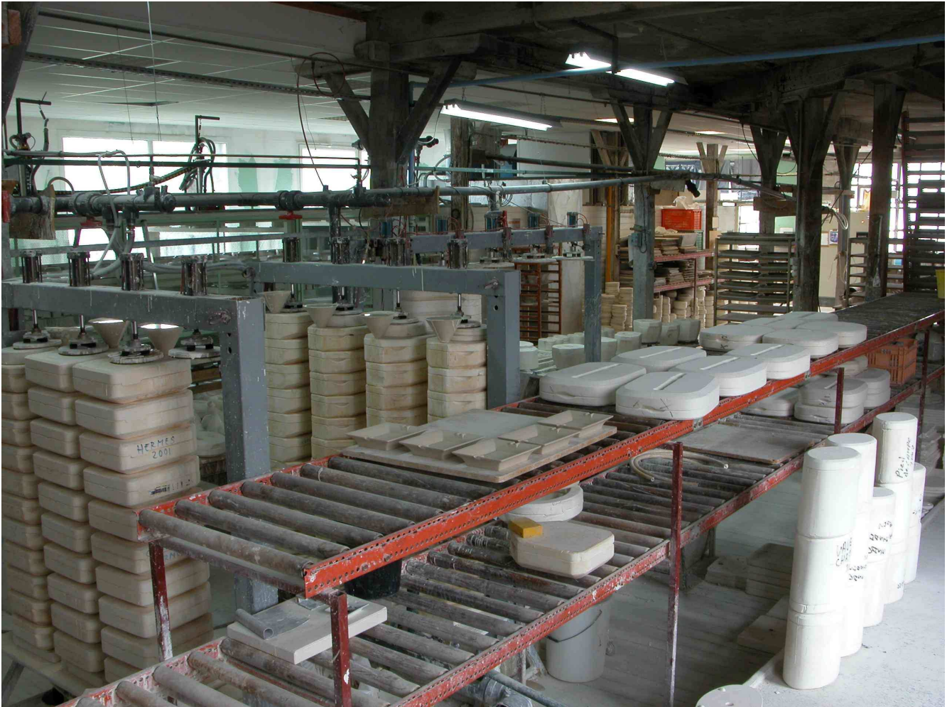
Fig.25 Atelier de coulage : machine automatique (Elmeceray).
