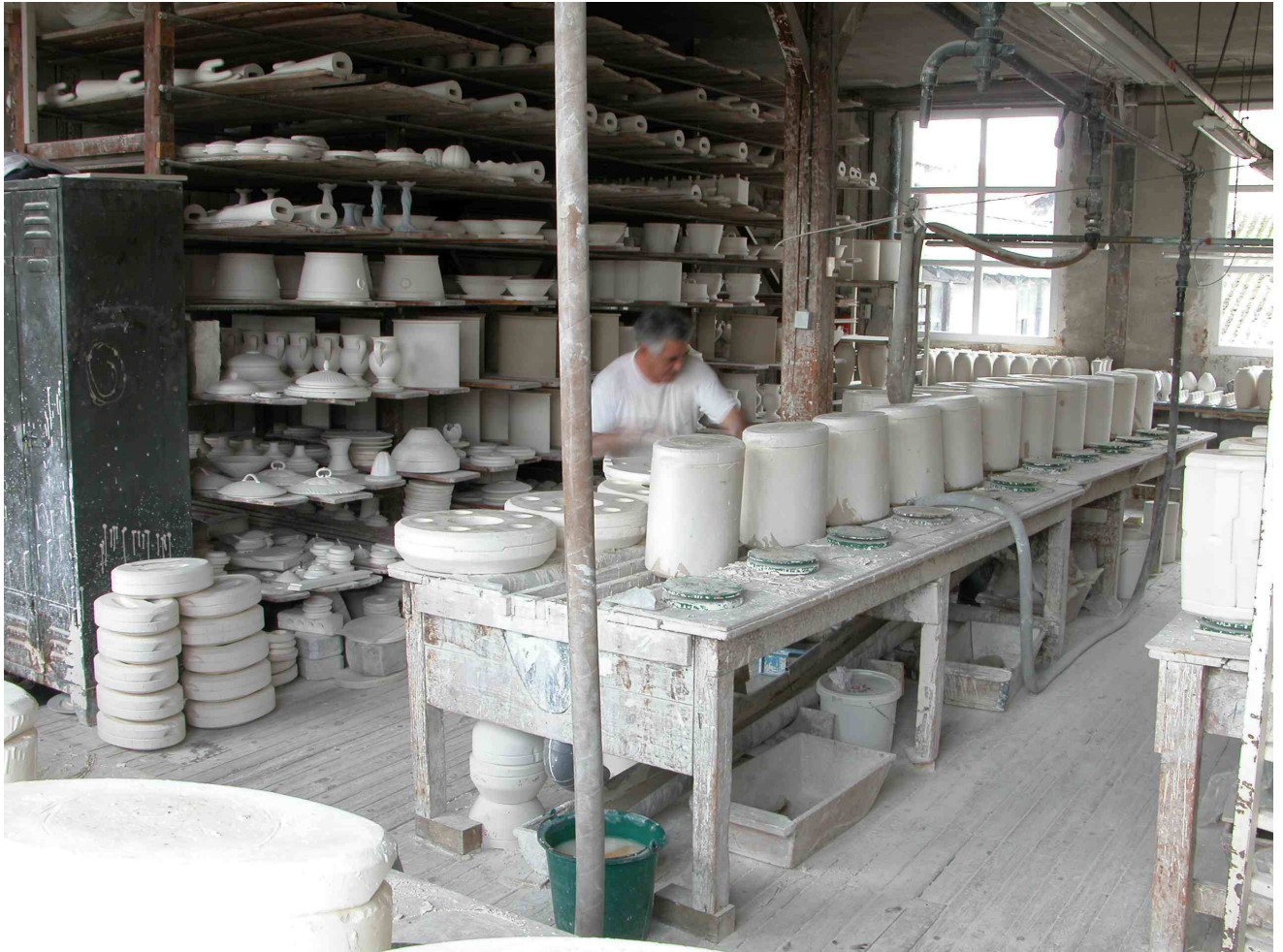
Fig.18 Atelier de coulage des grosses pièces. Vue générale.
