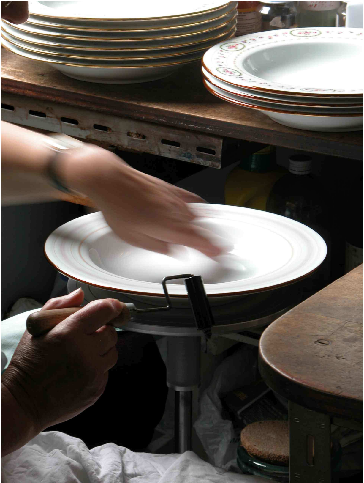
Fig.52 Pose d'un filet à l'aide d'une tournette.
