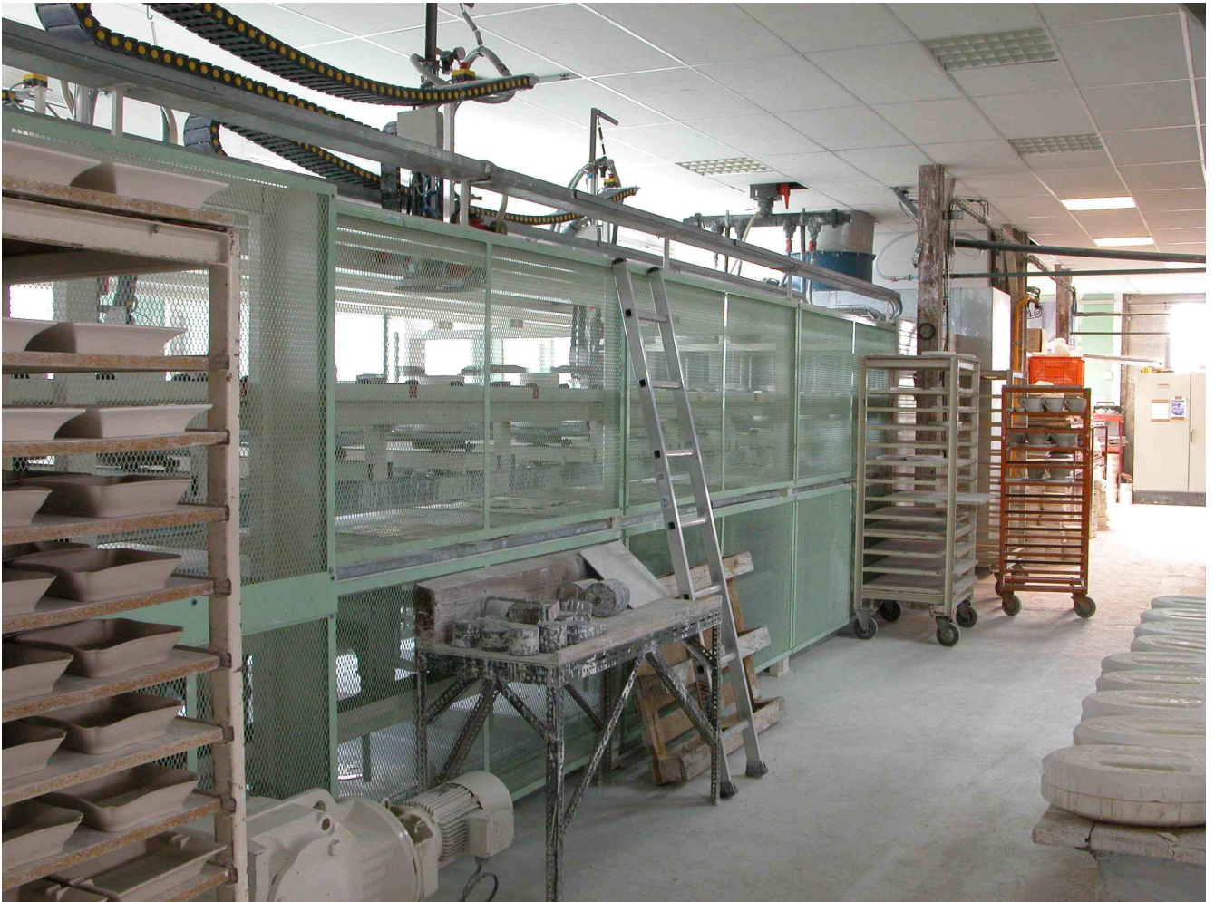
Fig.26 Atelier de coulage : machine automatique (Elmeceray). Détail.
