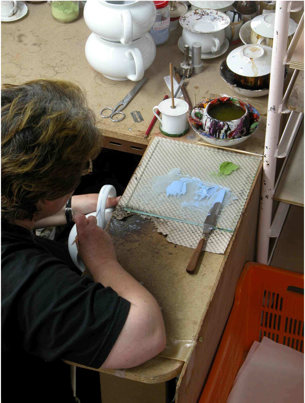
Fig.48 Pose d'un filet au pinceau, sur l'anse d'une cafetière.
