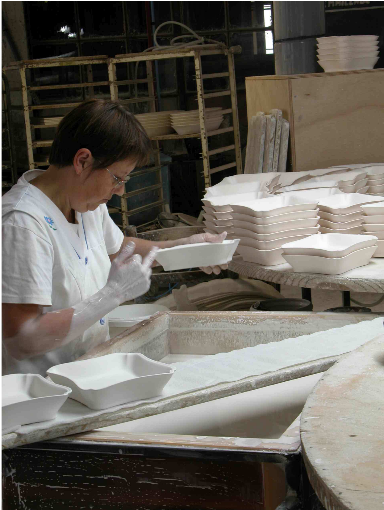
Fig.45 Opération d'émaillage : finition de l'émail avant la phase de séchage.
