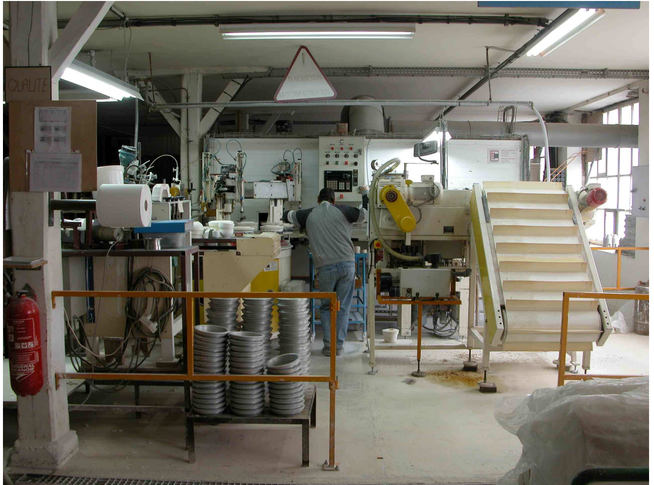
Fig.40 Atelier de moulage à la housse des tasses : machine automatique.
