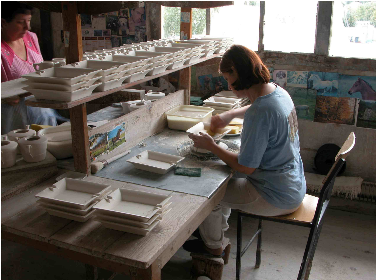
Fig.28 Atelier de coulage : finition des pièces coulées avant cuisson de dégourdi.
