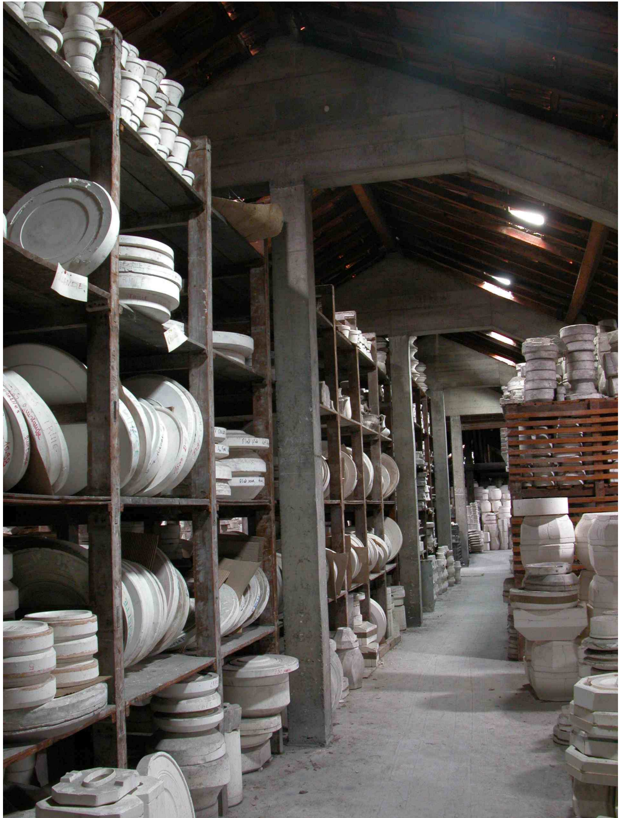
Fig.35 Stockage des moules pour le coulage dans les greniers des ateliers de fabrication (charpente en béton).
