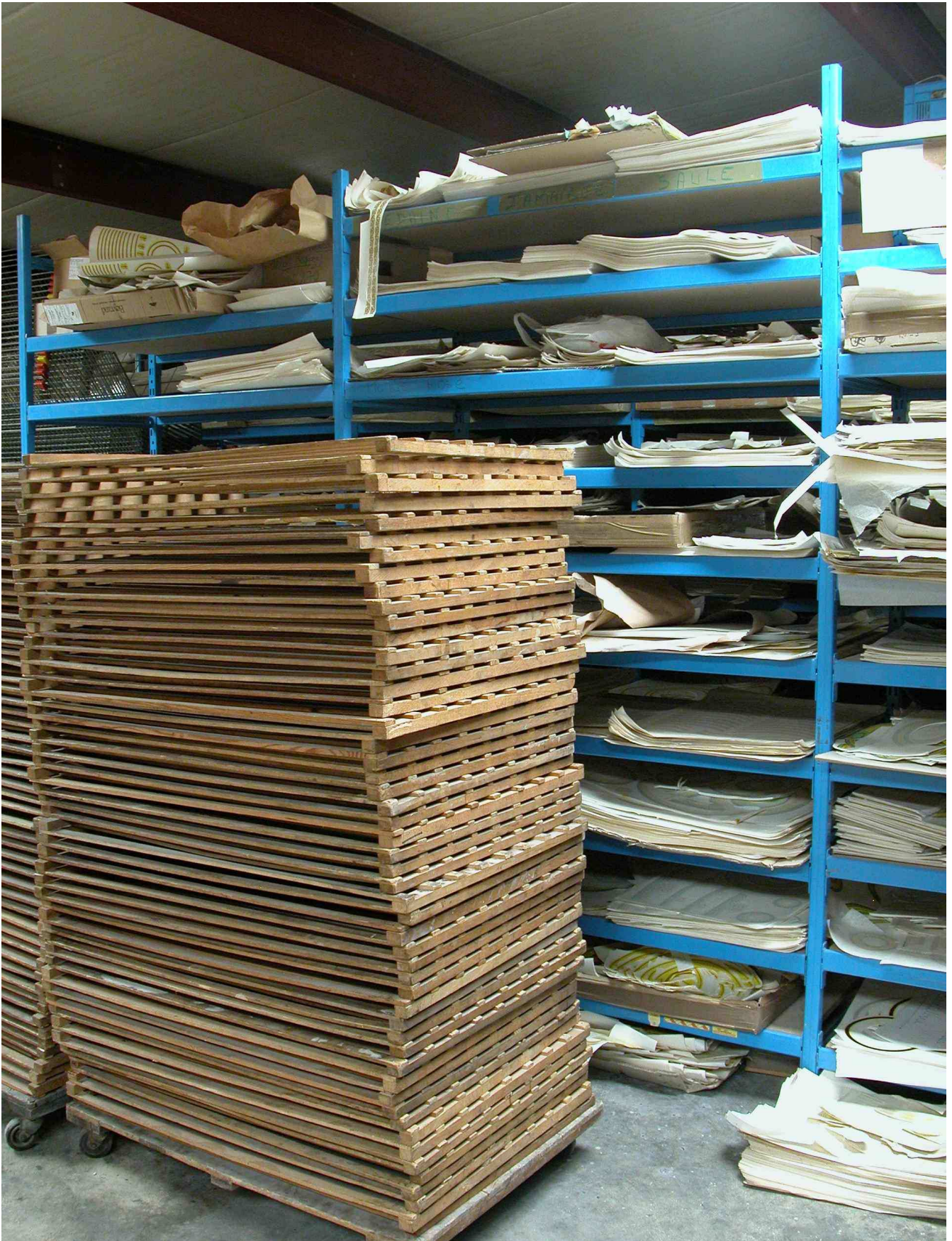
Fig.67 Atelier d'imprimerie : claies de séchage des planches chromolithographiques.
