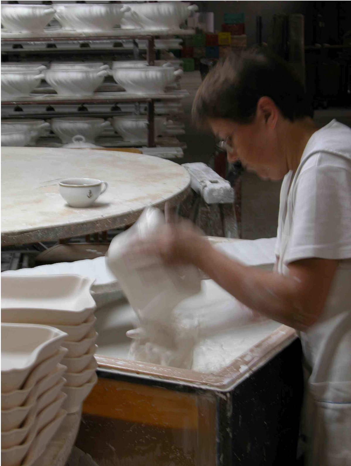
Fig.42 Opération d'émaillage : la pièce à émailler après une brève immersion dans un bain d'émail liquide.
