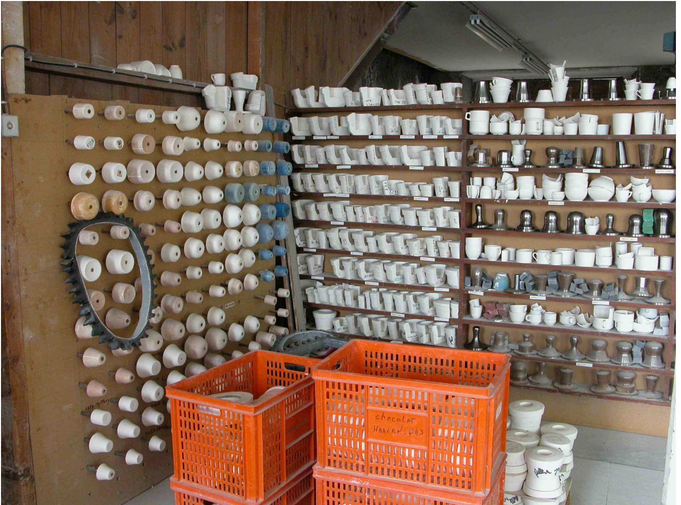
Fig.41 Atelier de moulage à la housse des tasses : stockage des moules de la machine automatique.
