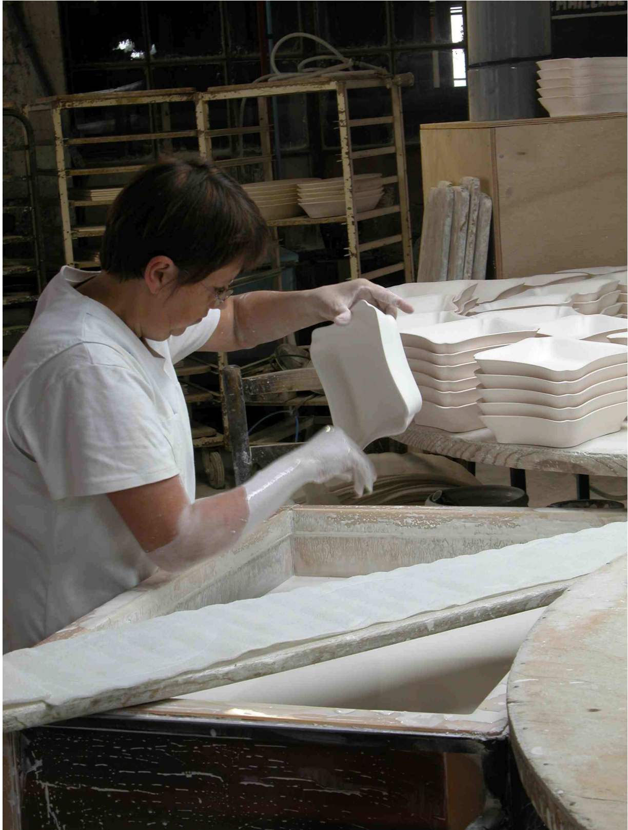
Fig.44 Opération d'émaillage : enlèvement de la goutte d'émail qui subsiste après l'égouttage de la pièce.
