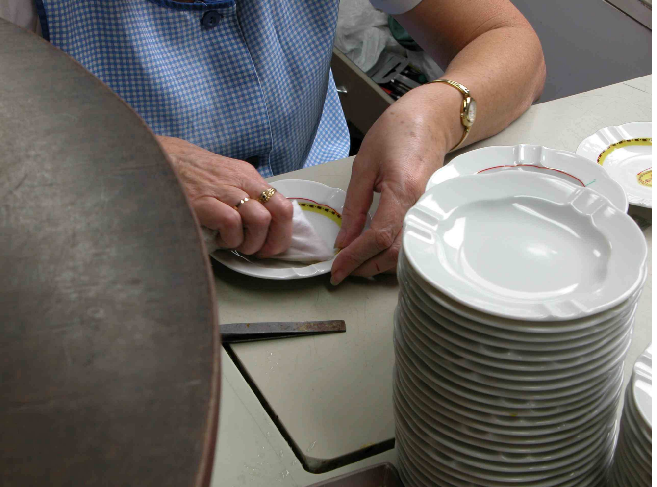
Fig.54 Pose de décalcomanies sur une soucoupe.
