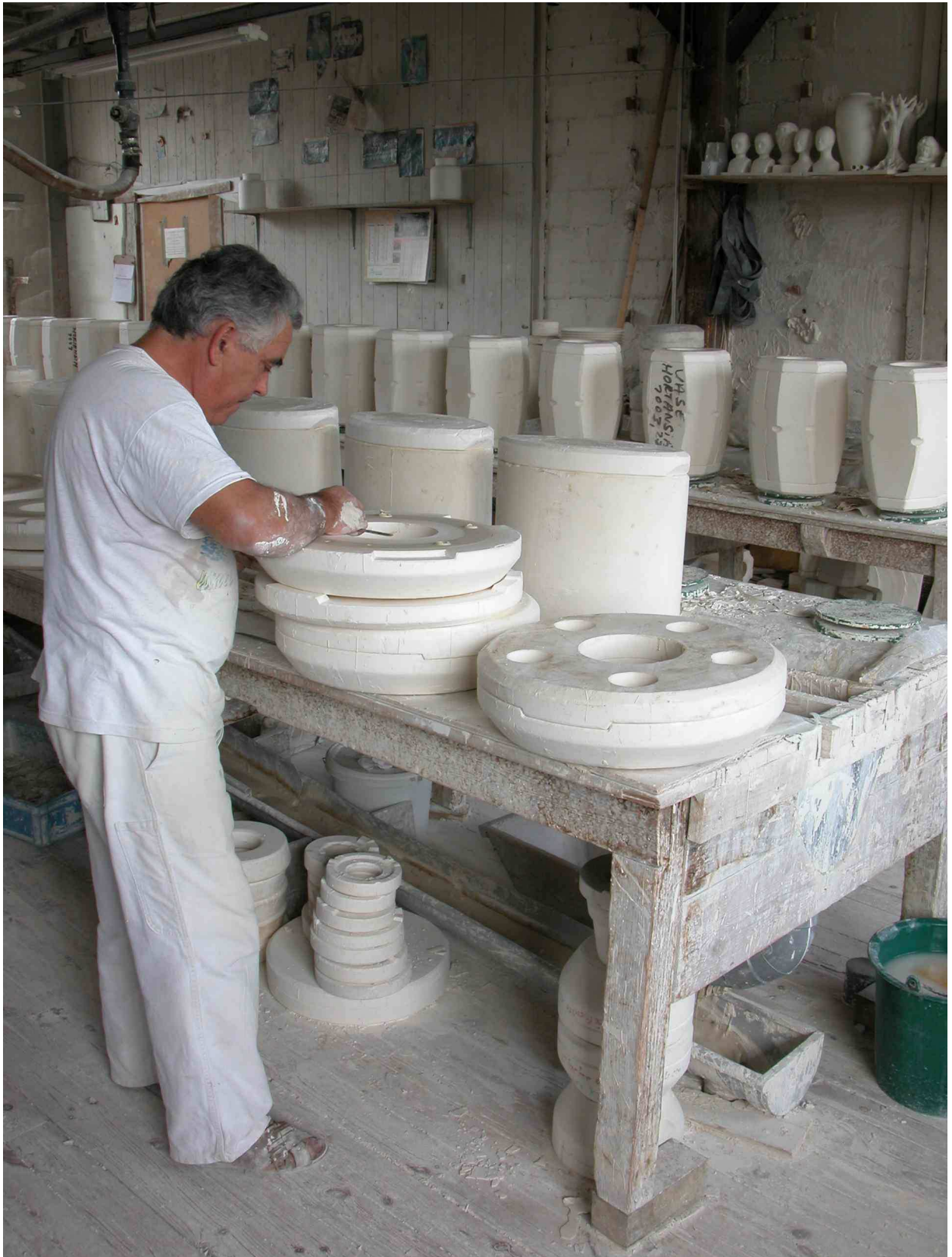
Fig.19 Atelier de coulage des grosses pièces. Opération de démoulage sur la table de coulage.
