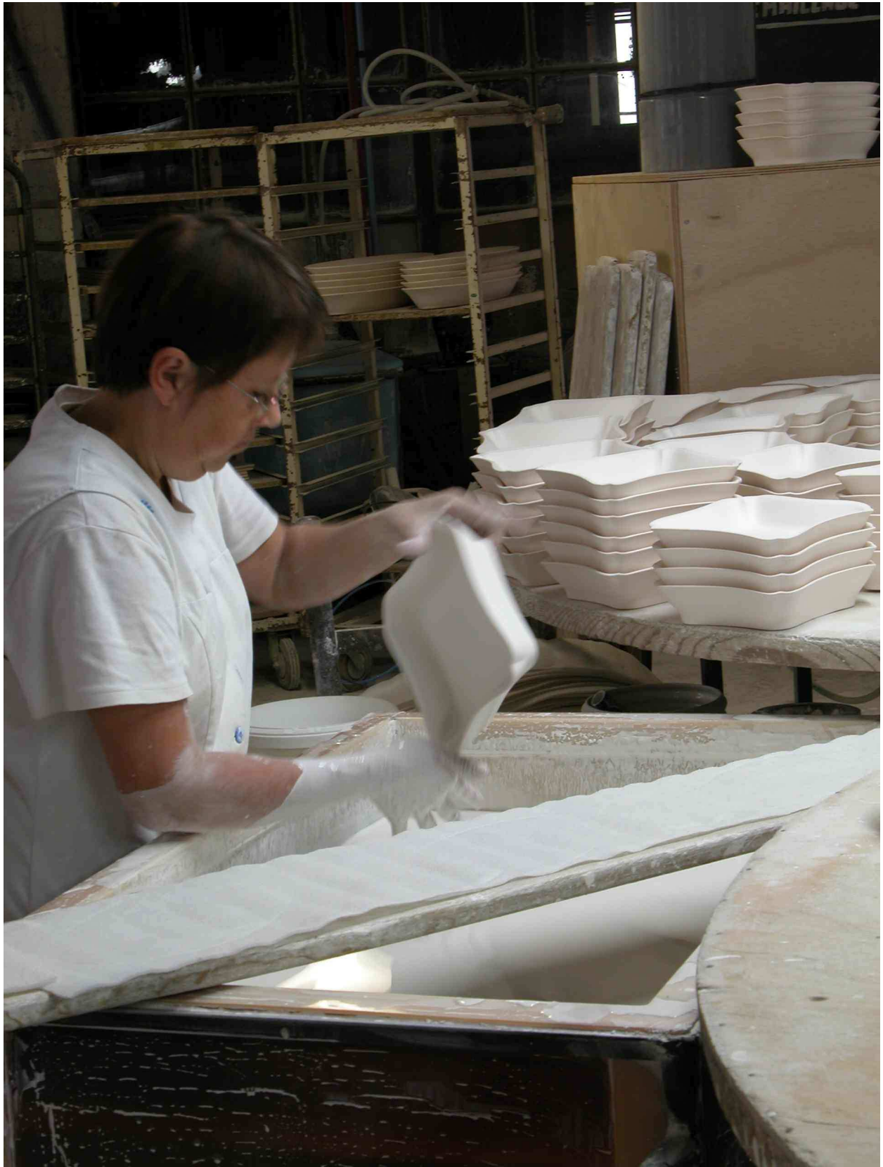
Fig.43 Opération d'émaillage : égouttage de la pièce après immersion dans un bain d'émail liquide.
