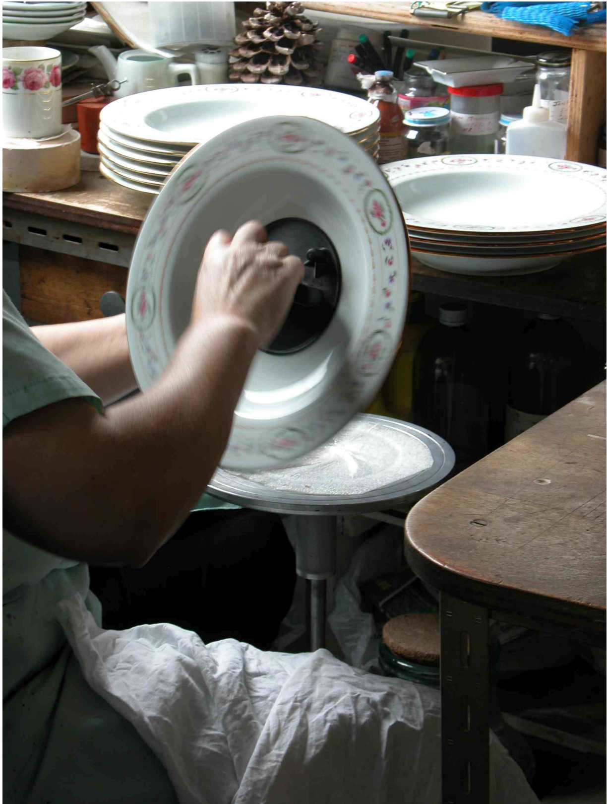
Fig.53 Vérification après la pose d'un filet à l'aide d'une tournette sur un plat. Ce dernier est manipulé par l'intermédiaire d'une ventouse.
