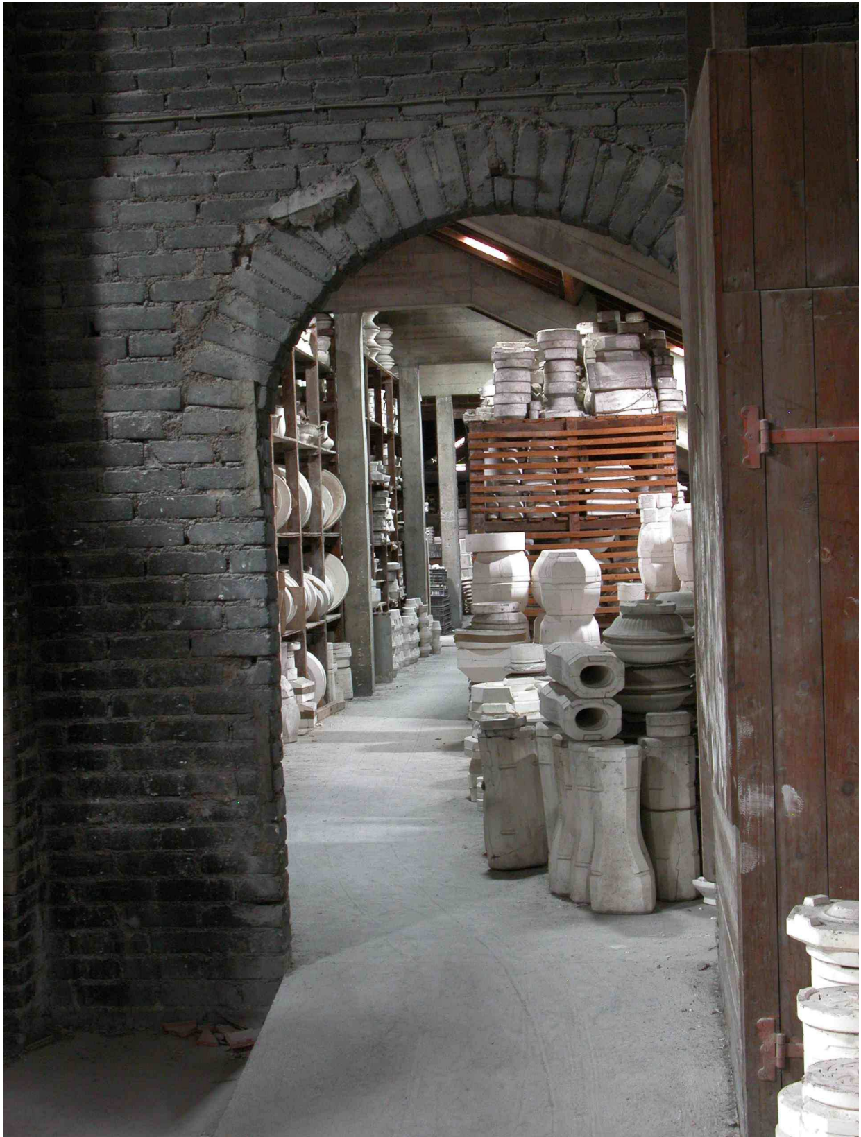
Fig.34 Stockage des moules pour le coulage dans les greniers des ateliers de fabrication.
