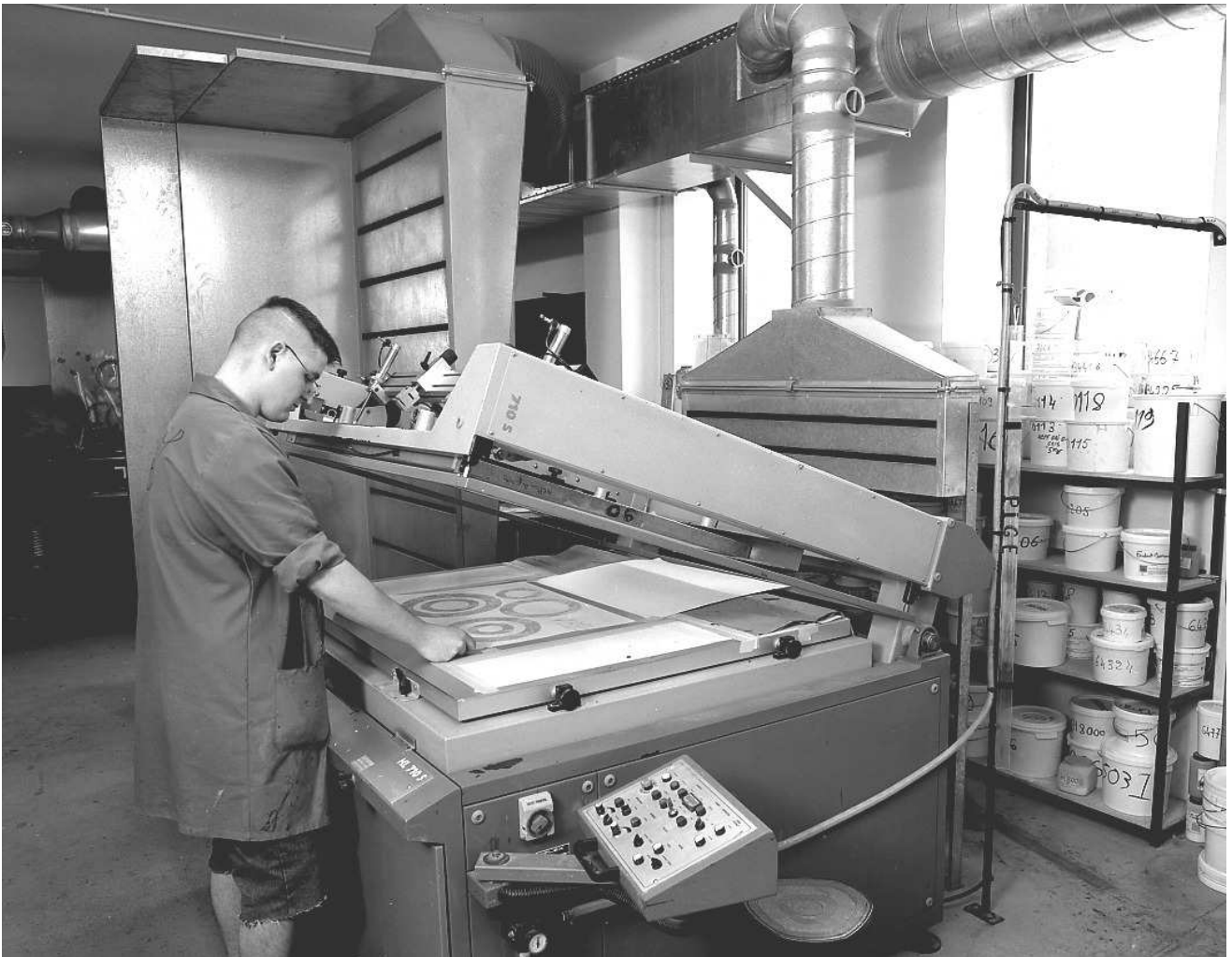
Fig.27 Atelier de sérigraphie : impression des décors sérigraphiés pour la décoration par décalque.
