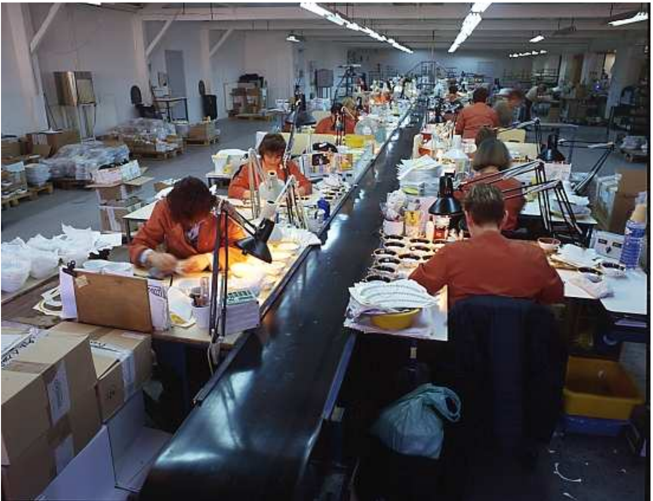
Fig.23 Ateliers de décor : atelier de décalcomanie. Les postes de travaillent sont alignés de part et d'autre d'une bande transporteuse, où sont déposées les pièces décorées.
