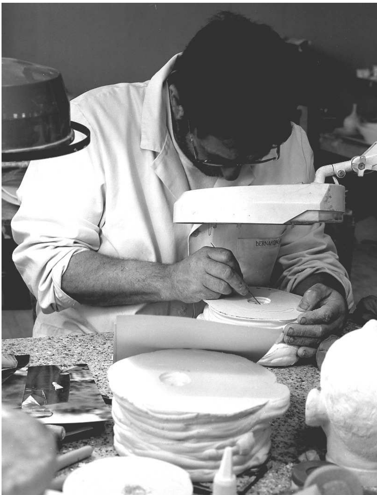
Fig.14 Atelier de modelage : le modeleur grave un moule en plâtre pour la réalisation d'un médaillon à l'effigie du roi de Thaïlande.
