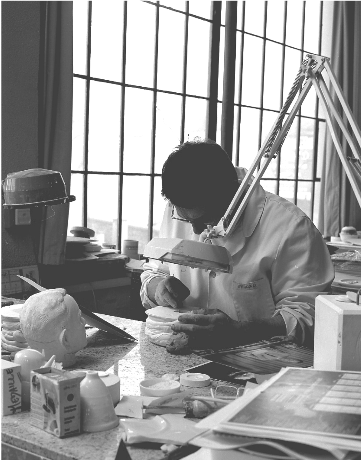
Fig.13 Atelier de modelage : le modeleur grave un moule en plâtre pour la réalisation d'un médaillon à l'effigie du roi de Thaïlande.
