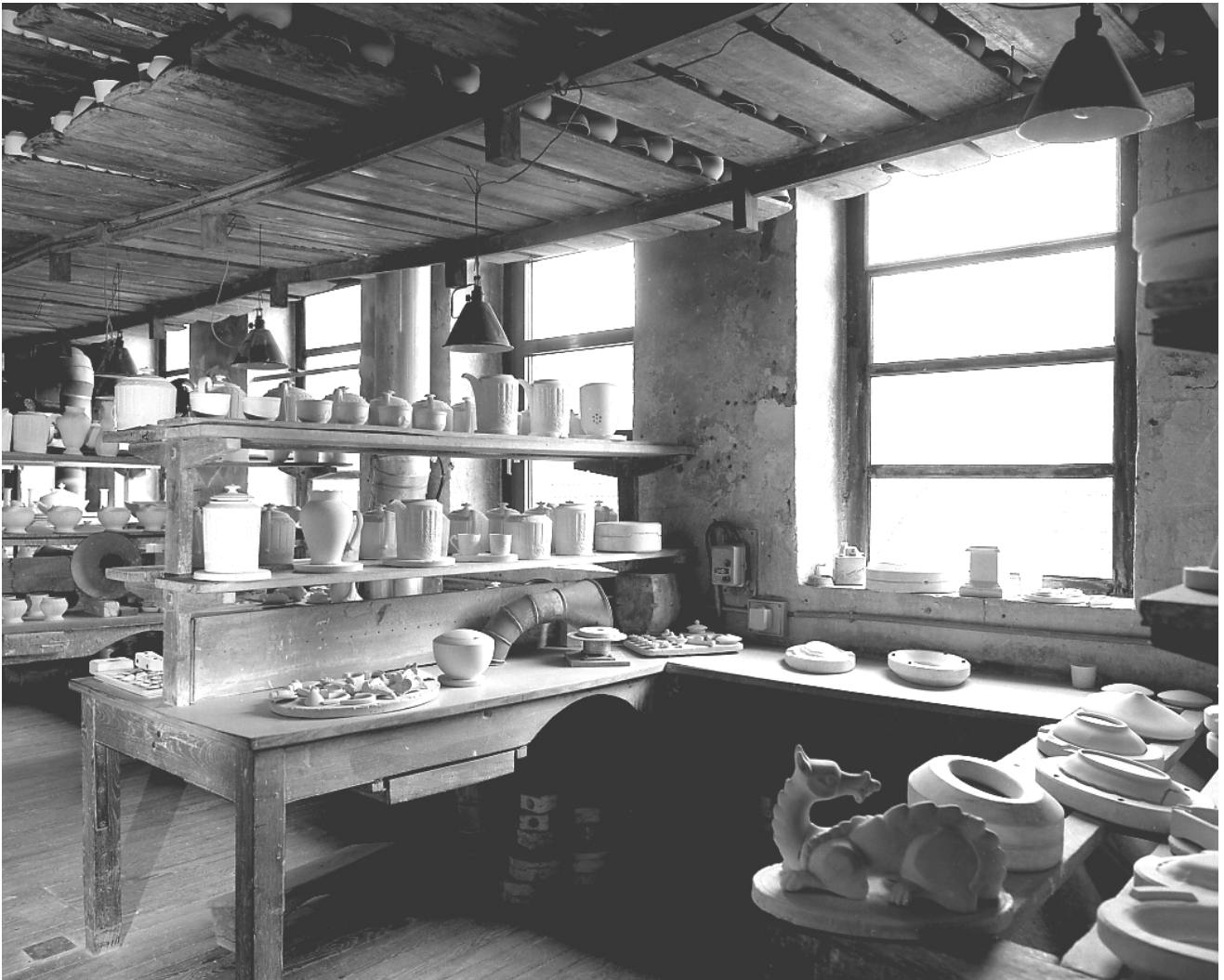
Fig.16 Ancien atelier de fabrication (exposition muséographique) : à droite une table de coulage, à gauche un poste de finition des pièces.
