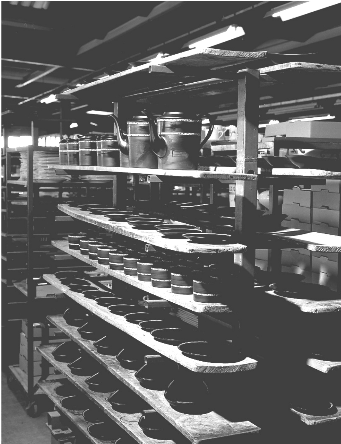
Fig.20 Gravure à l'acide fluorhydrique (incrustation) : les pièces de porcelaine avant gravure. Les parties sombres (brun foncé) sont les surfaces protégées de l'action de l'acide par un vernis.
