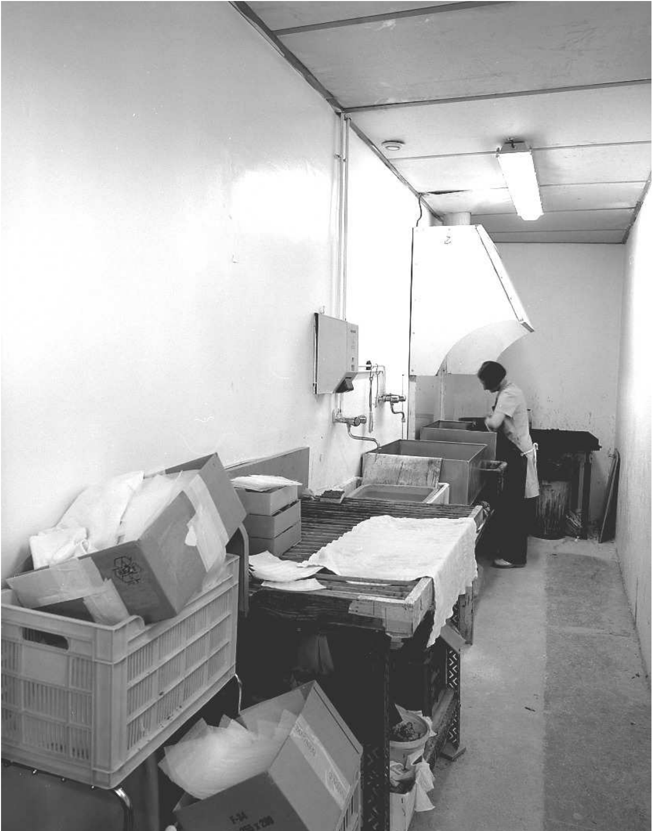
Fig.21 Gravure à l'acide fluorhydrique (incrustation) : vue générale de l'atelier (bacs de gravure et de rinçage).
