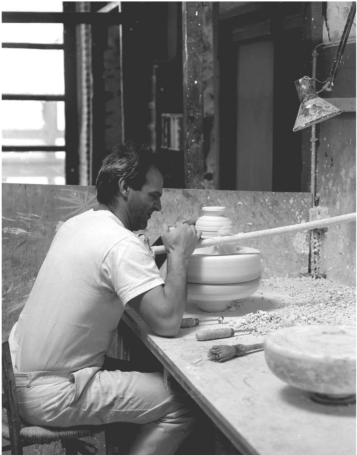
Fig.11 Opération de modelage : phase finale du tournassage. La partie supérieure du modèle en plâtre est dégagée de la masse brute. Le modelleur achève le tournassage de la base du modèle.
