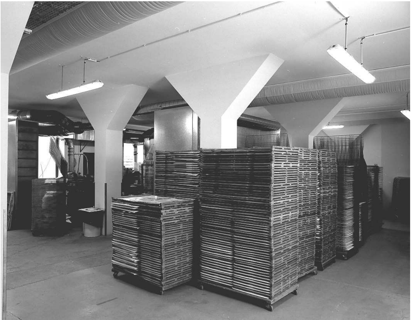
Fig.28 Atelier de sérigraphie : séchage des planches de décalcomanie sur des claies en bois ou métalliques.
