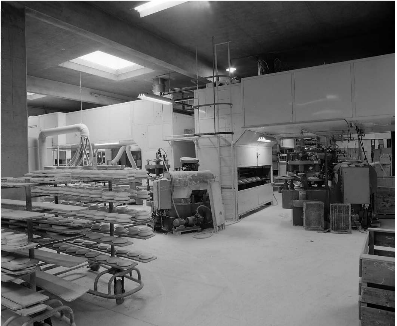
Fig.44 Atelier de fabrication : machine CASBURT et pont de séchage Ph. Inv. Cl. Thibaudin CASBURT. 88870853X
