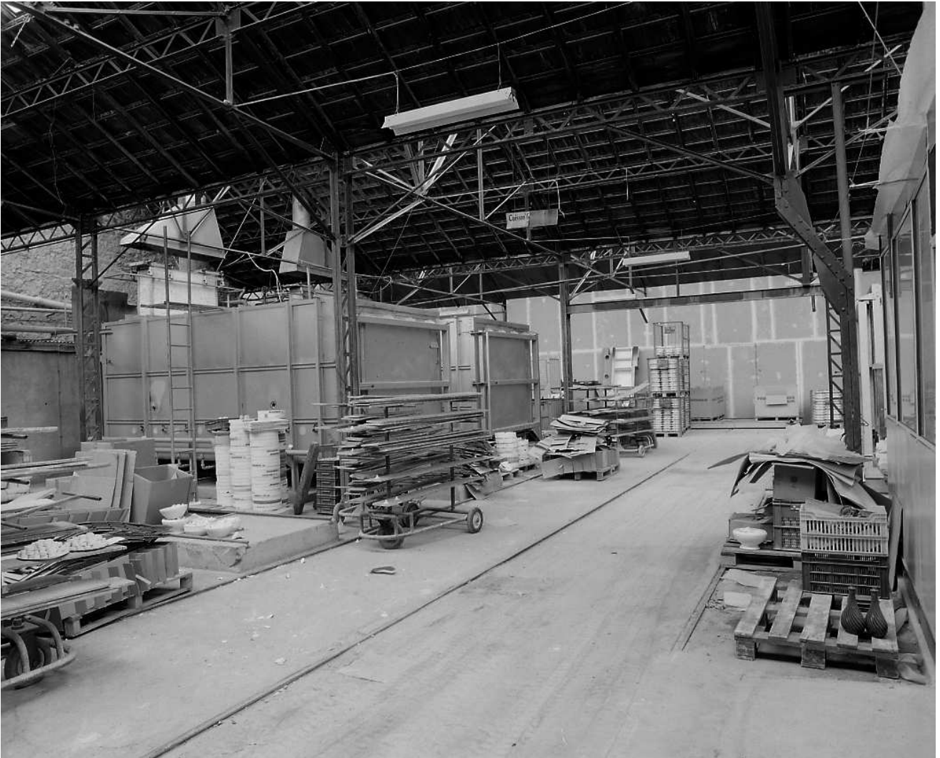
Fig.67 Anciens fours-cellules électriques pour la cuisson au grand feu à 1400°C.
