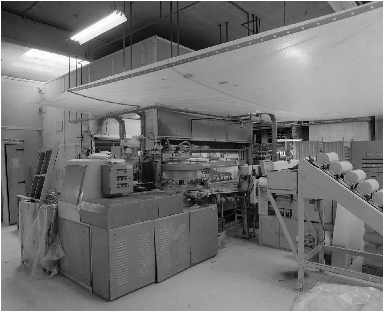
Fig.48 Atelier de fabrication : fabrication des assiettes en continu sur machine NETZSCH.
