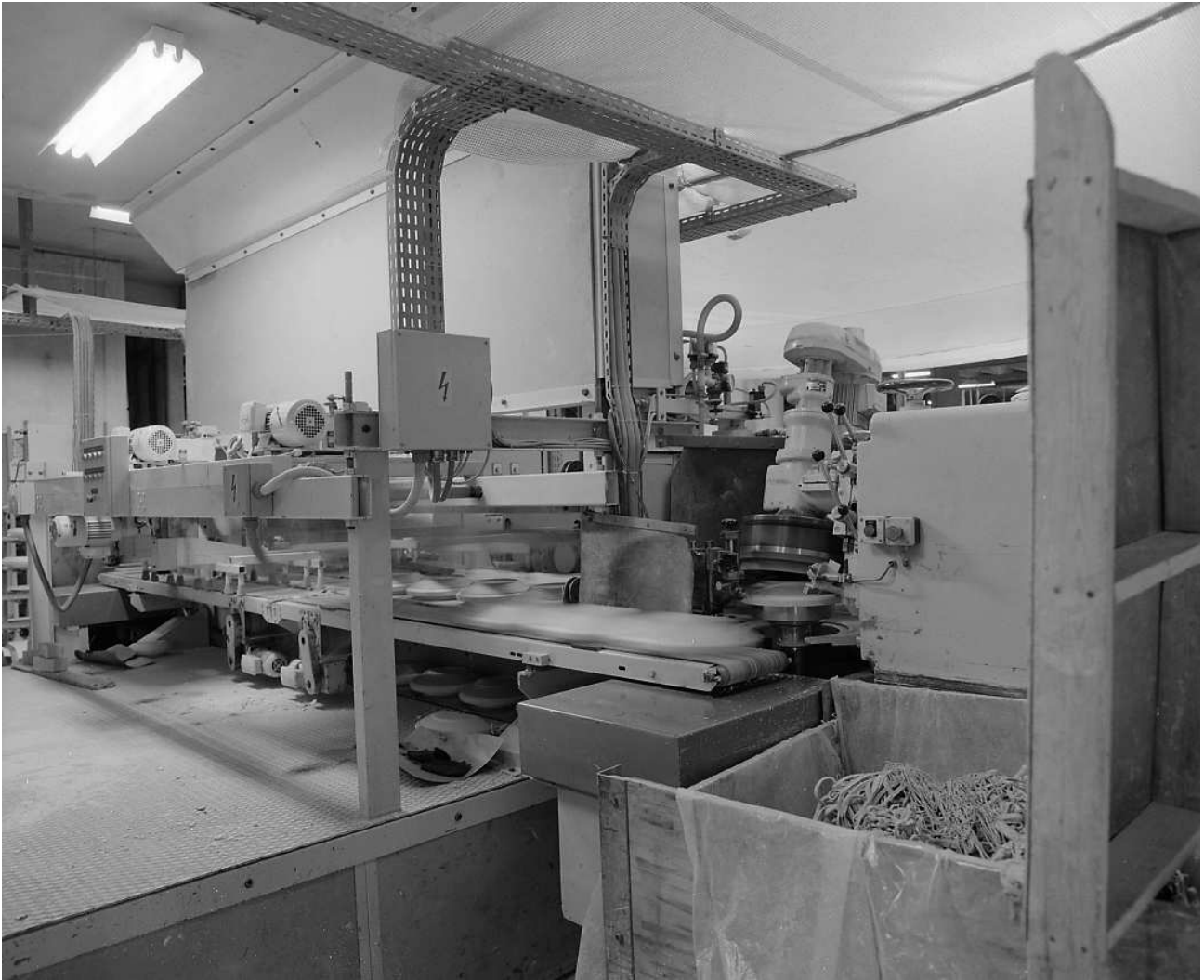
Fig.49 Atelier de fabrication : fabrication des assiettes en continu sur machine NETZSCH.
