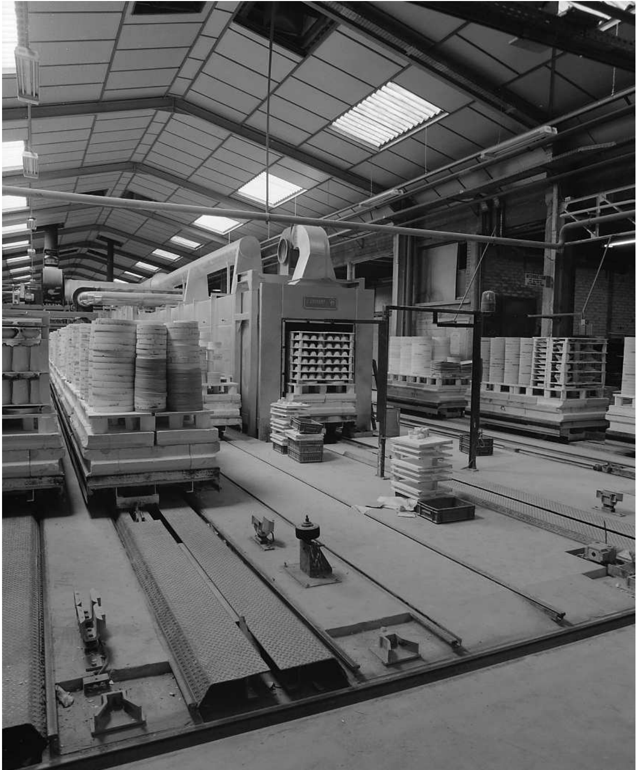
Fig.66 Four-tunnel COUDAMY pour la cuisson au grand feu à 1400°C.
