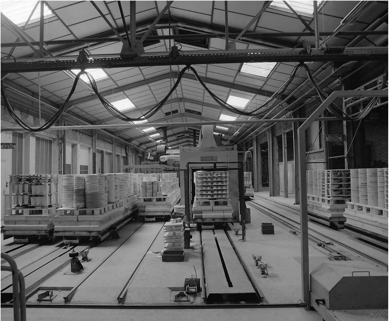
Fig.65 Four-tunnel COUDAMY pour la cuisson au grand feu à 1400°C.
