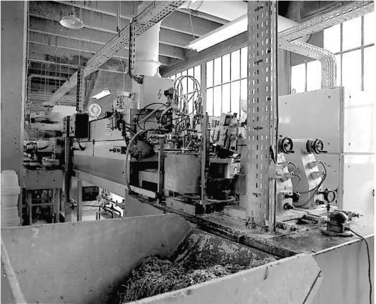
Fig.53 Atelier de coulage : calibreuse à tasses NETZSCH (Bâtiment G). Chaîne de fabrication automatique.
