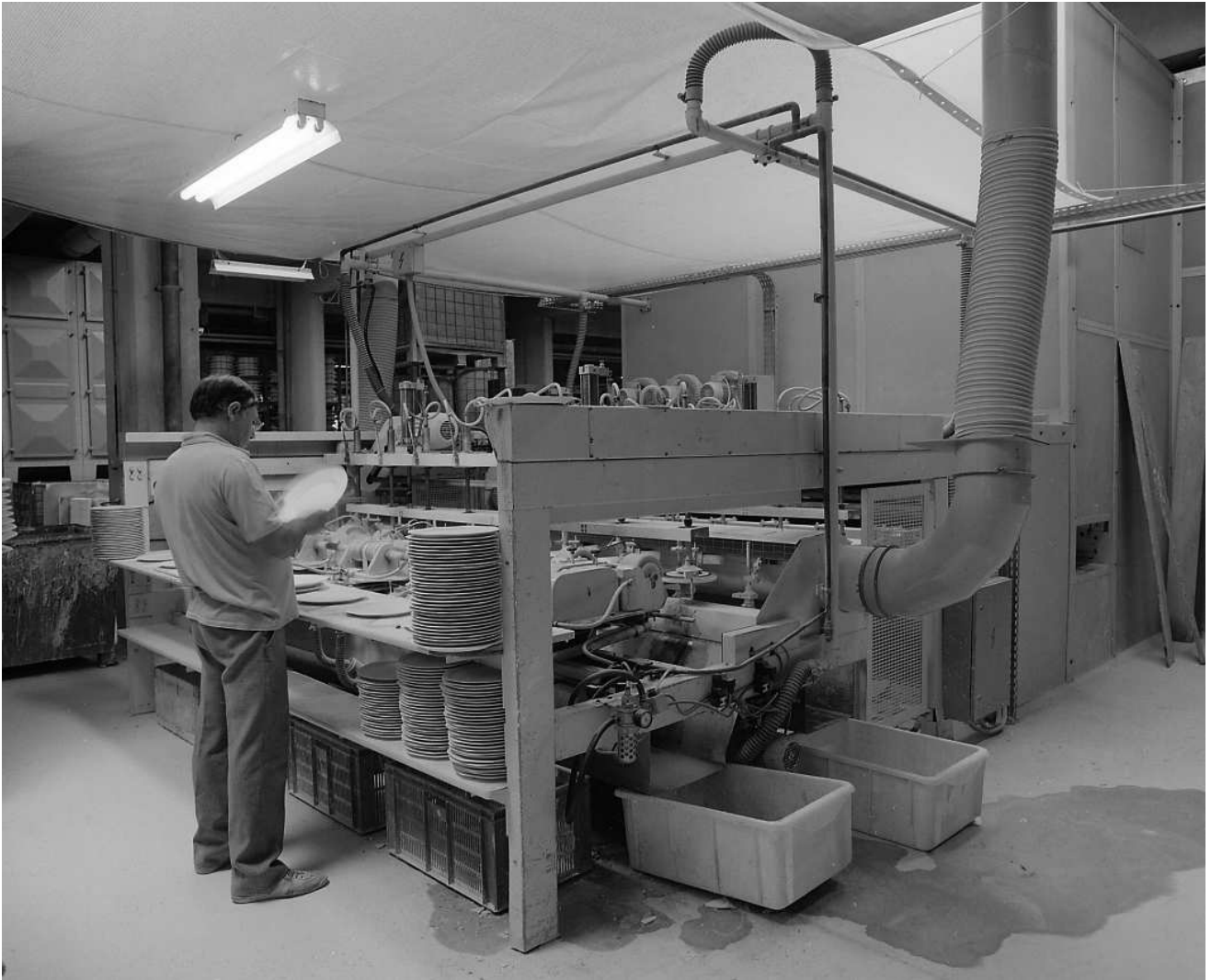
Fig.46 Atelier de fabrication : machine CASBURT. "Choisissage" et finissage des assiettes à la sortie du séchoir.
