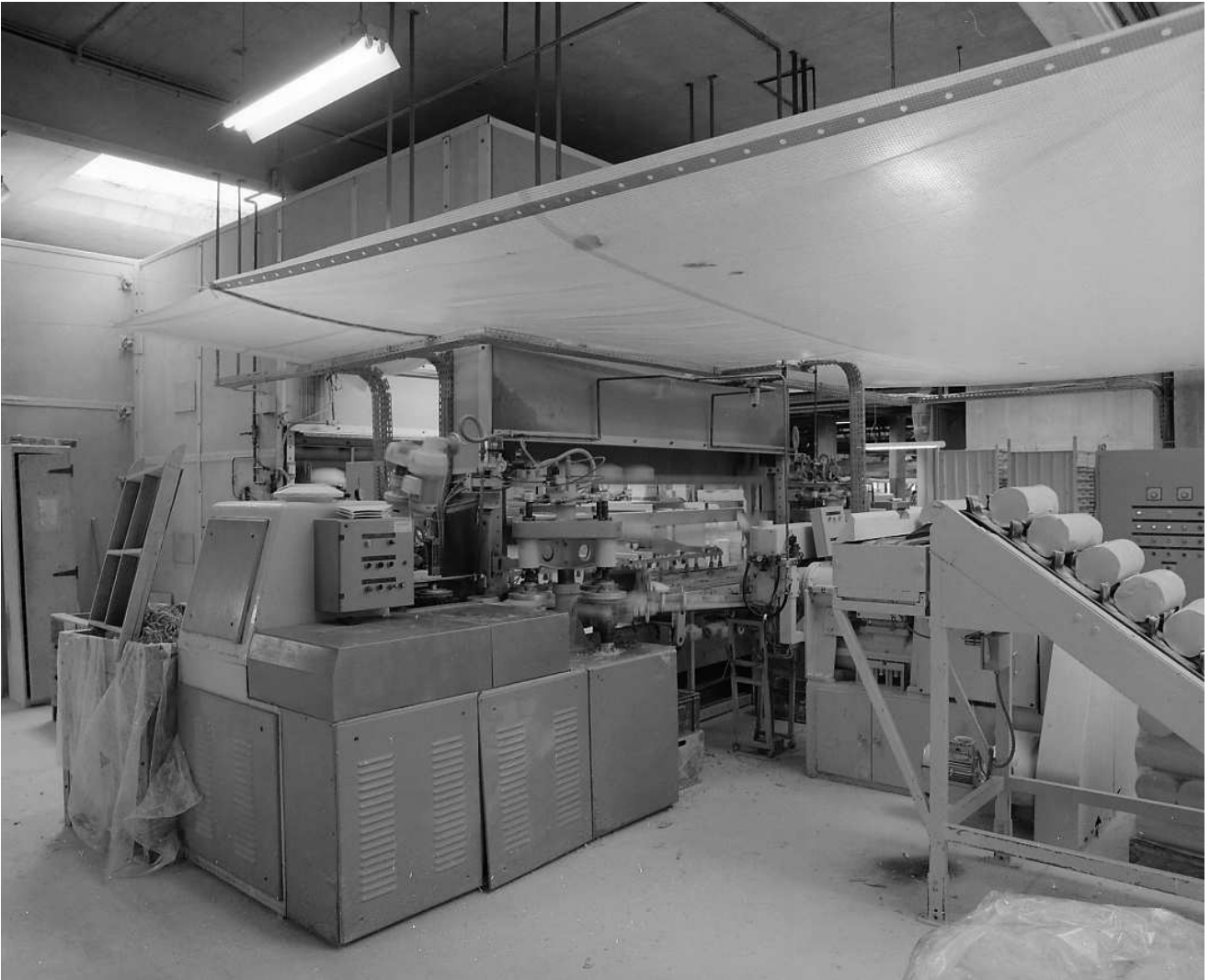
Fig.47 Atelier de fabrication : fabrication des assiettes en continu, machine NETZSCH.
