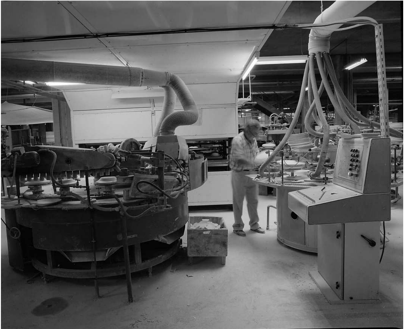
Fig.45 Atelier de fabrication : machine CASBURT. "Choisissage" des assiettes et finition. Ph. Inv. Cl. Thibaudin 88870860X
