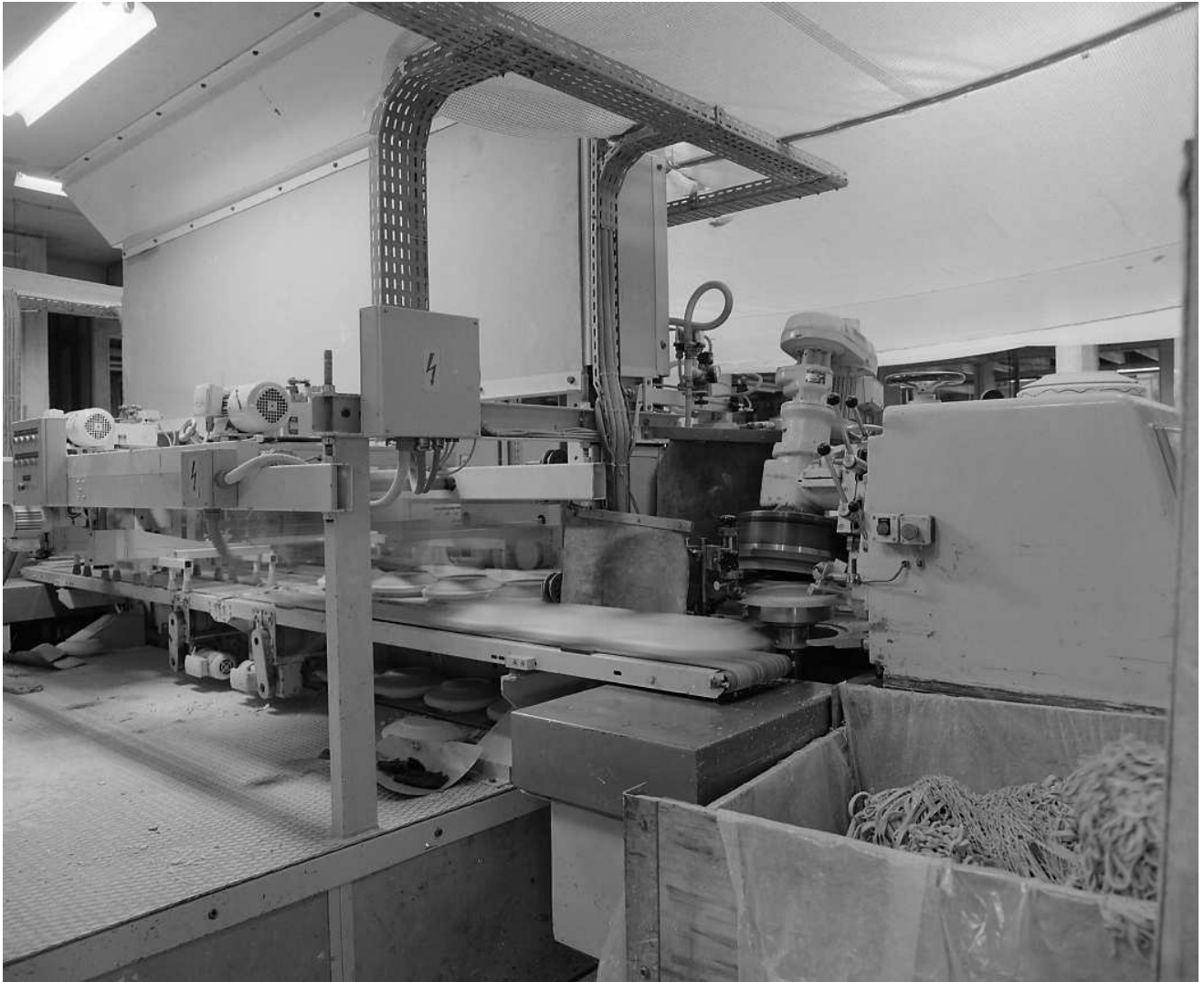
Fig.50 Atelier de fabrication : fabrication des assiettes en continu sur machine NETZSCH (calibreuse).
