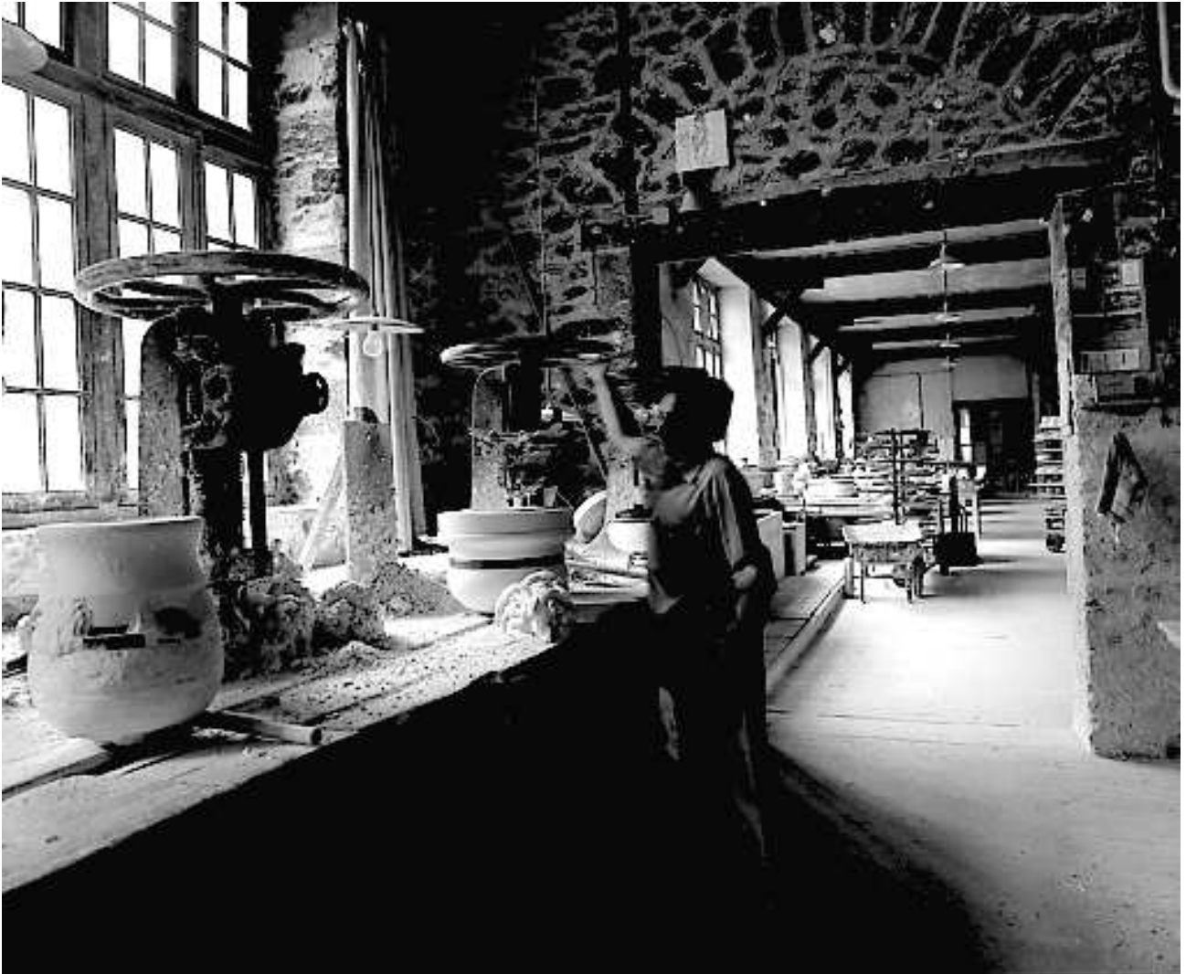
Fig.30 Atelier de calibrage : fabrication des moules (calibreuse à main).
