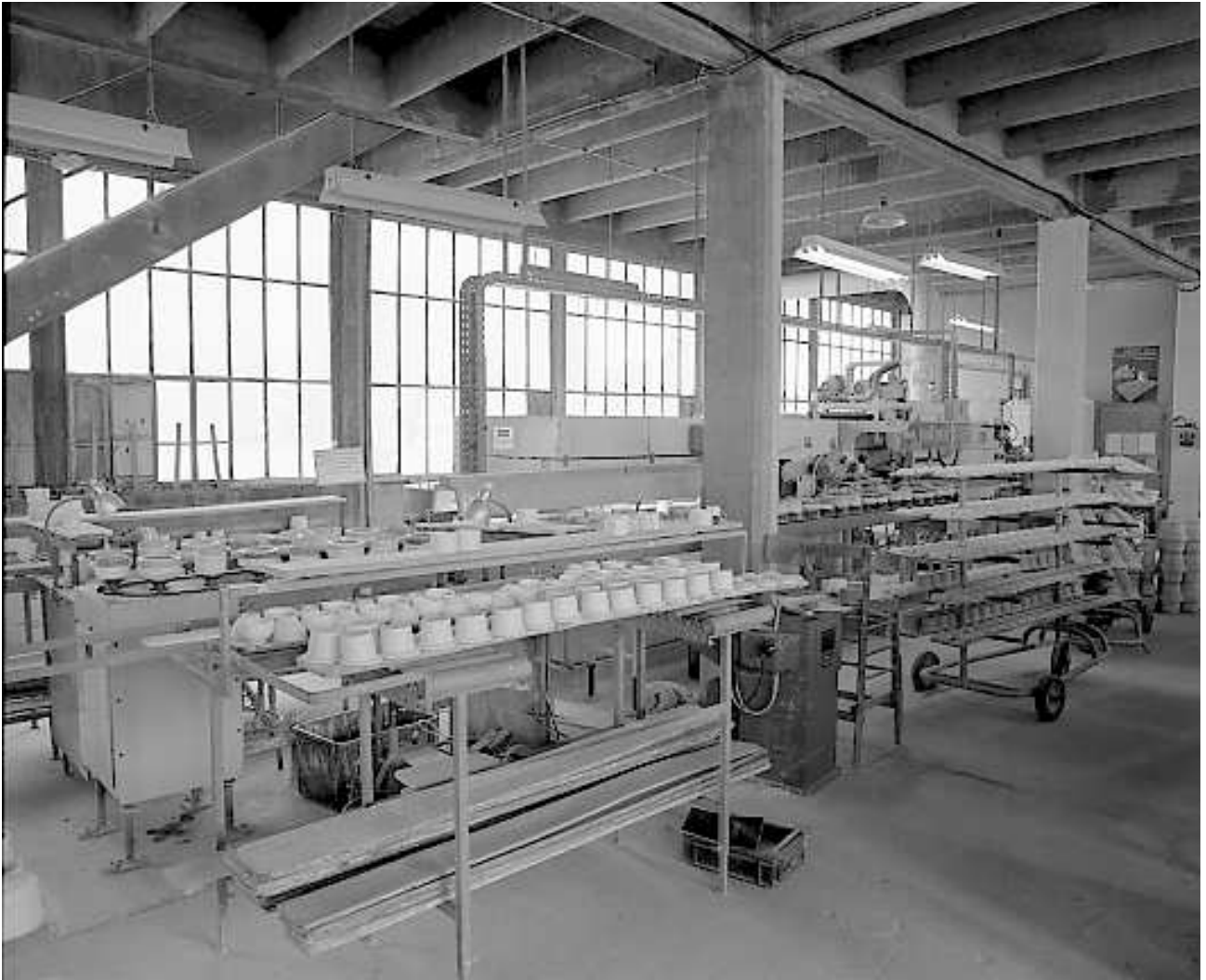
Fig.51 Atelier de coulage : calibreuse à tasses NETZSCH (Bâtiment G). Chaîne de fabrication automatique.
