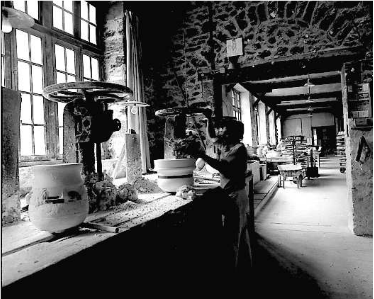
Fig.29 Atelier de calibrage : fabrication des moules (calibreuse à main).
