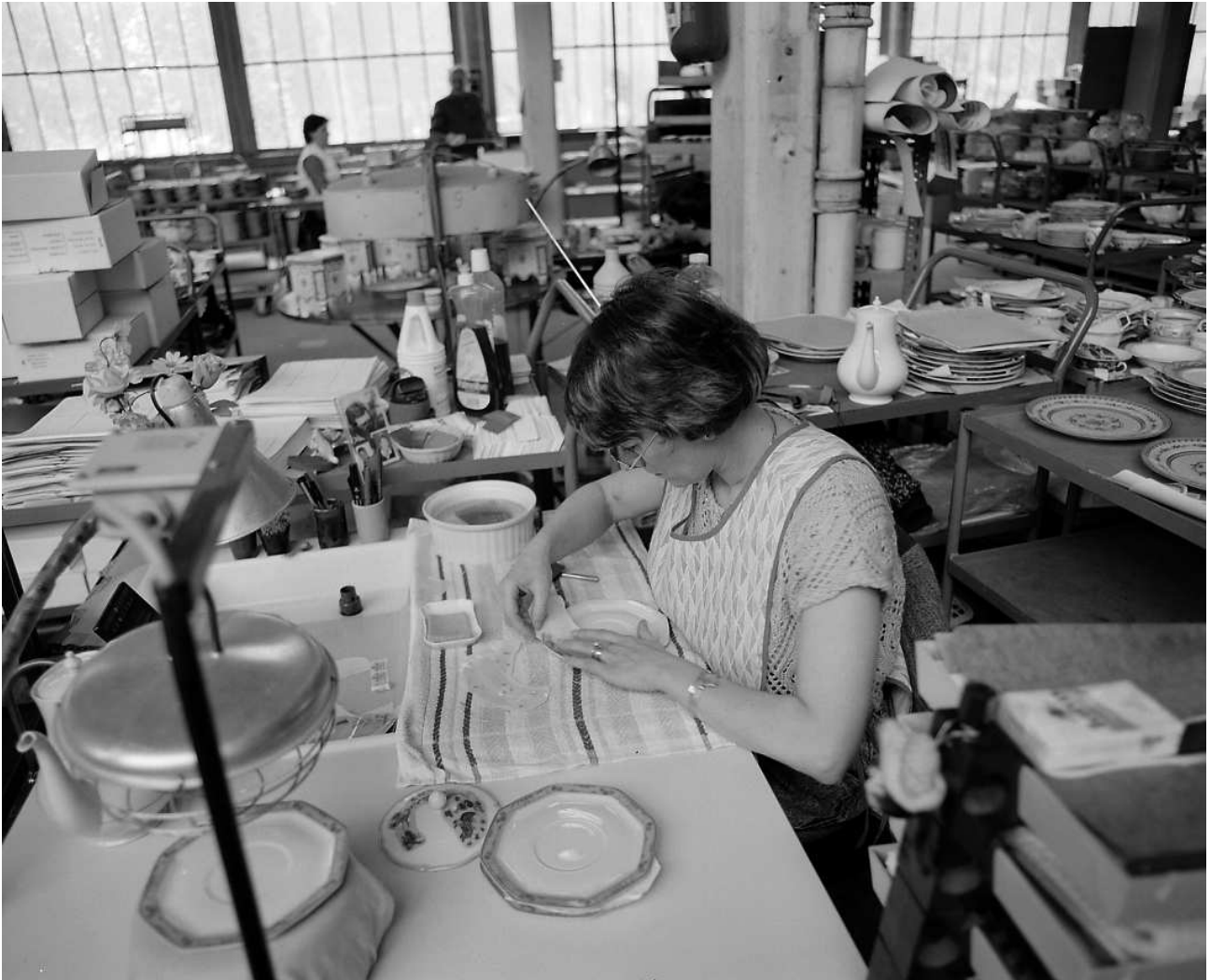
Fig.73 Atelier de décalque. Détail poste de travail d'une décalqueuse : application d'un chromo. Ph. Inv. Cl. Thibaudin 88870833X
