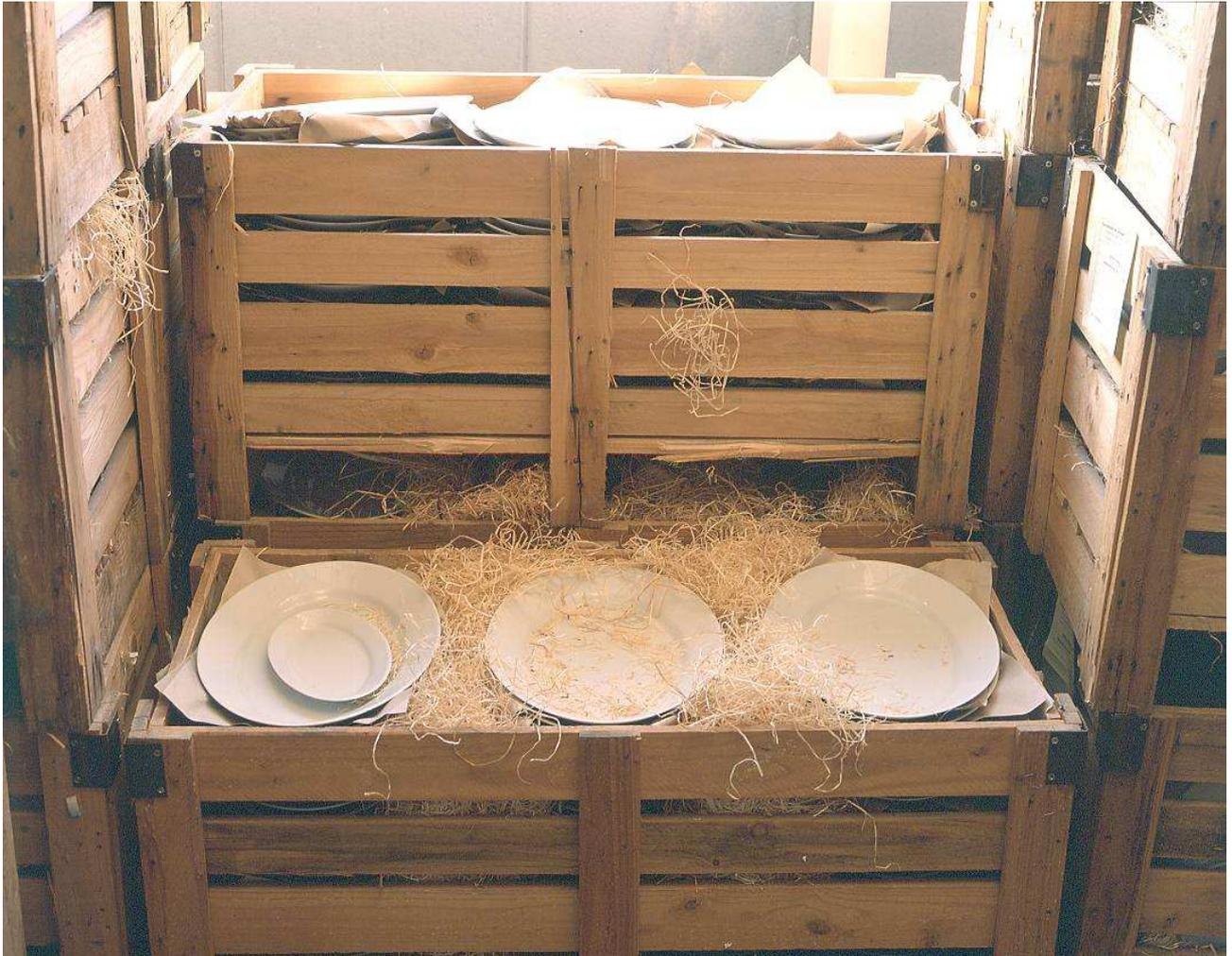
Fig.5 Atelier de tri de la porcelaine blanche, avant application du décor (opération de "choisissage").
