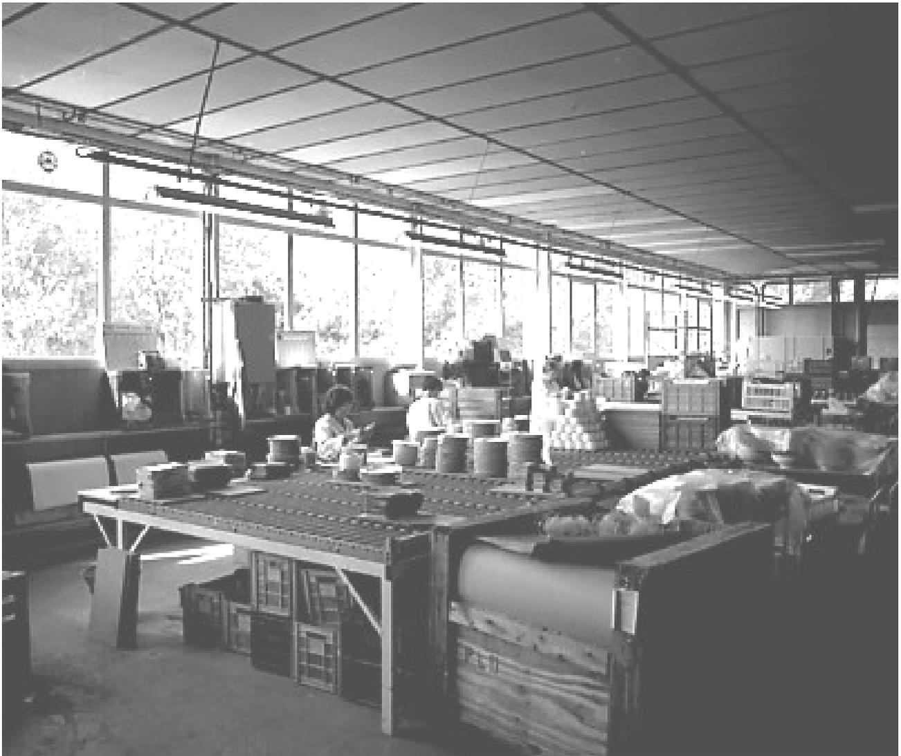
Fig.6 Atelier de décoration : à gauche la décoration par décalcomanie, à droite les fileurs. Ph. Inv. Ph. Rivière 02870486X
