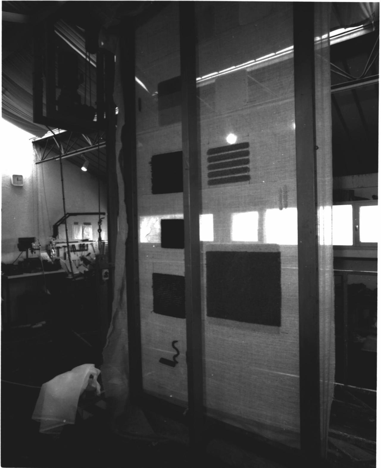
Fig. 20 Réalisation d'échantillons de tapis "hand-tuft". Sur une toile de coton, tendue à l'aide d'un métier vertical, une ouvrière implante à l'aide d'un pistolet à laine, le velours formant le duvet du tapis. La cohésion avec la toile est ensuite assurée par un encollage. Au premier plan à droite, un ourdissoir, appareil qui, relié au pistolet, fournit la laine.
