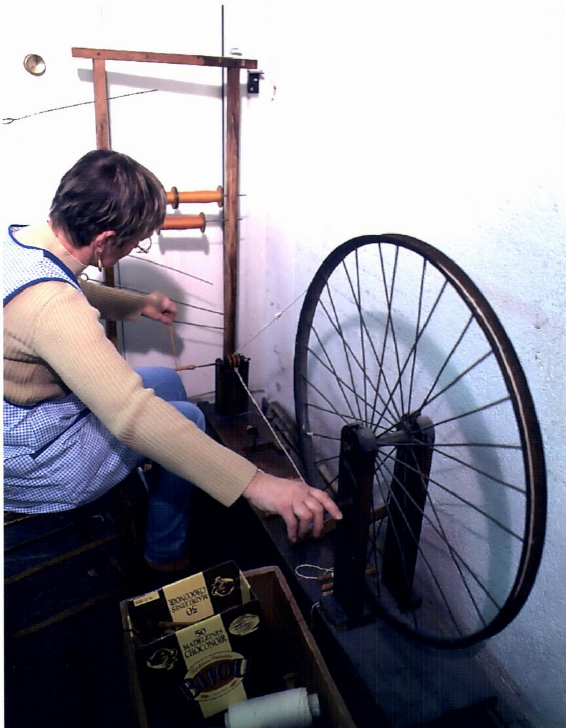
Fig. 8 Montage et préparation de la chaîne sur un métier à tisser de basse lisse.
