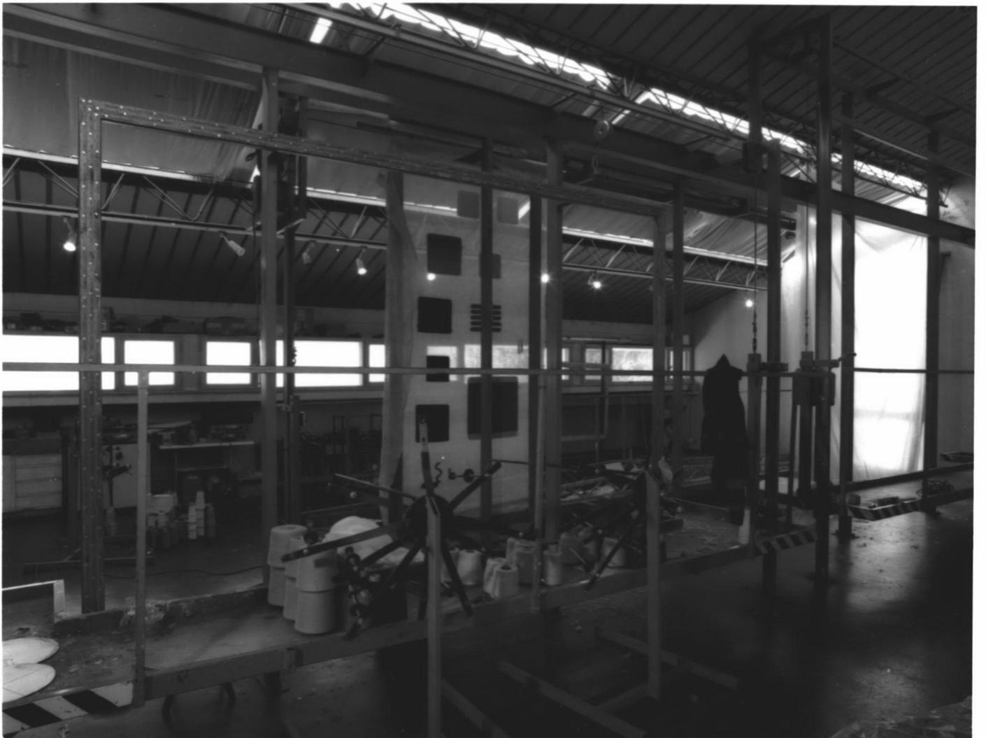
Fig. 19 Vue arrière d'un métier à tisser les tapis selon la méthode de "hand-tufting".
